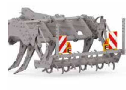
WARNTAFEL MIT BELEUCHTUNG
