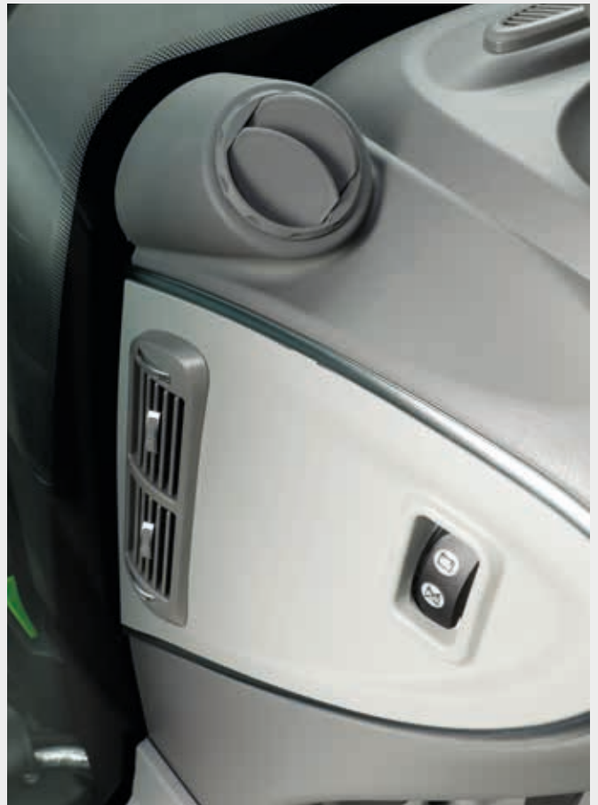
Neue verstellbare Luftauslässe und der Batterieschalter sind bequem an der Lenkkonsole angebracht.
