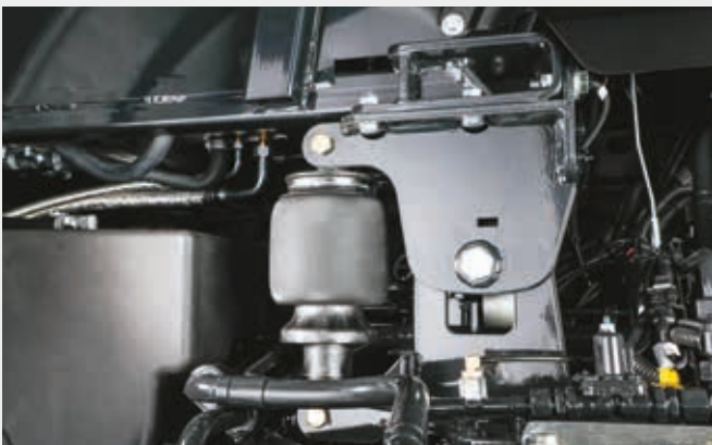
Luftfederelemente der komfortablen Kabinenfederung.
