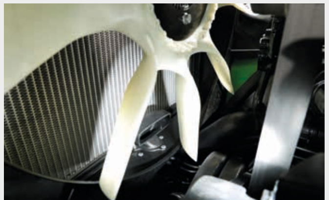
↑ Elektronischer Viscolüfter (eVisco) mit Ansaugschlauch für das Luftfilter-Vorreinigungssystem (entfernt 95 % der groben Partikel, bevor sie die Luftfilter erreichen können).
