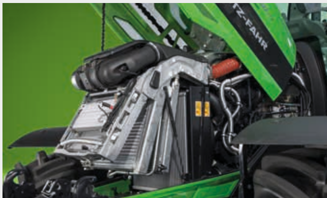
↑ Klappbares Aluminium-Kühlsystem des 6190 TTV mit Einhand-Entriegelung und Powercore-Luftfilter.
