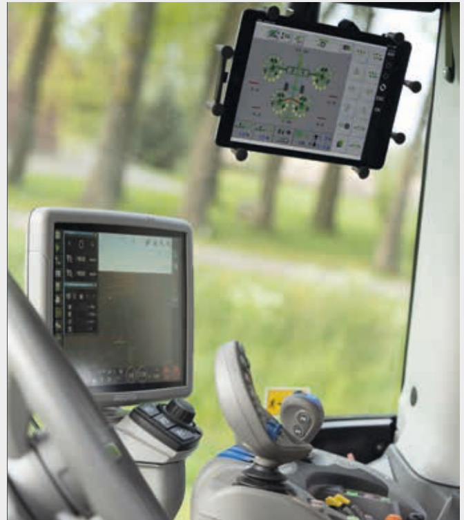
↑ Die XTEND-Funktion ermöglicht die Anzeige von SDF Guidance oder die Steuerung eines ISOBUS-Geräts auf einem externen Gerät, z. B. einem Tablet.
