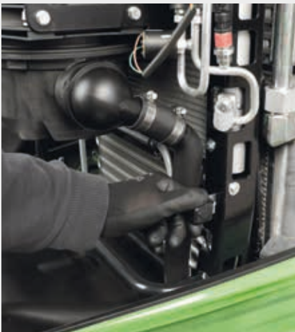
↑ Klappbares Kühlerpaket mit einfachem Öffnungsmechanismus.
