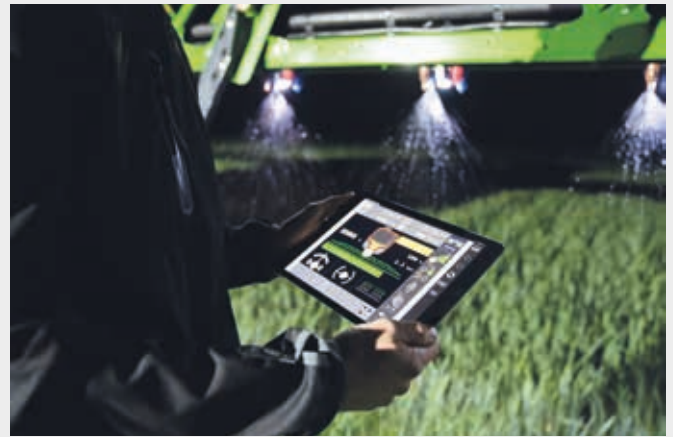
↑ XTEND-Funktion, die Bedienung von ISOBUS Anbaugeräten über ein Tablet auch außerhalb der Kabine.
