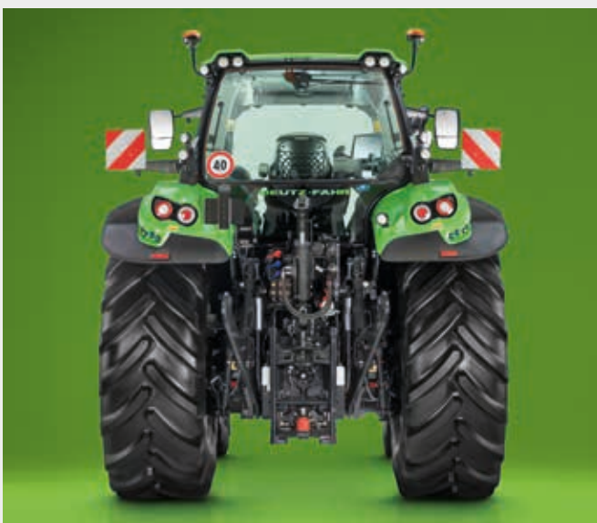
Das „Clean Oil System“ versorgt die Anbaugeräte mit bis zu 90 Litern Öl und sorgt dank der Wechselintervalle von 2.000 Stunden oder 2 Jahren für niedrigste Wartungskosten.
