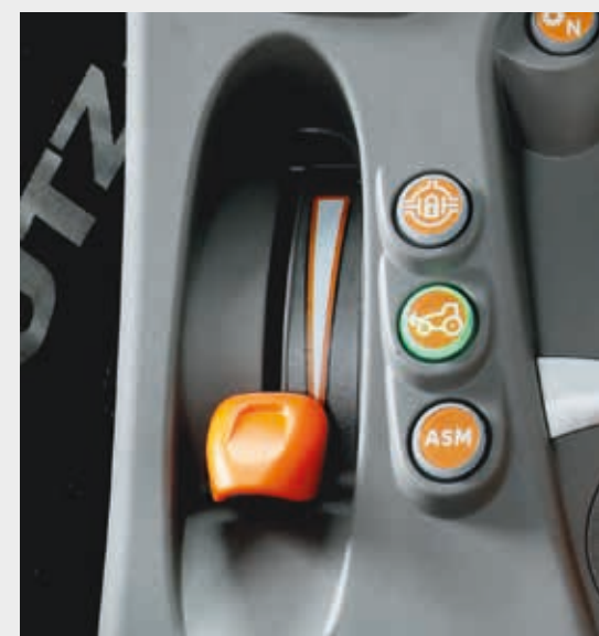
Unabhängiges Handgas und elektrohydraulische Aktivierung der Differenzialsperre, des Allradantriebs und der ASM-Funktion.
