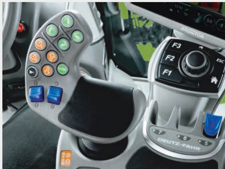
Ergonomischer MaxCom-Joystick mit Tasten für Kraftheber, Motor- und Getriebesteuerung, Vorgewendemanagement und zwei proportionalen Hydraulikventilen.
