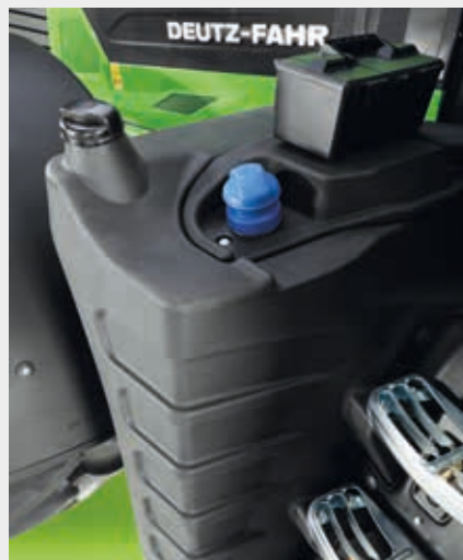
↑ Bis zu 505 l Kraftstofftank für längste Einsatzzeiten.
