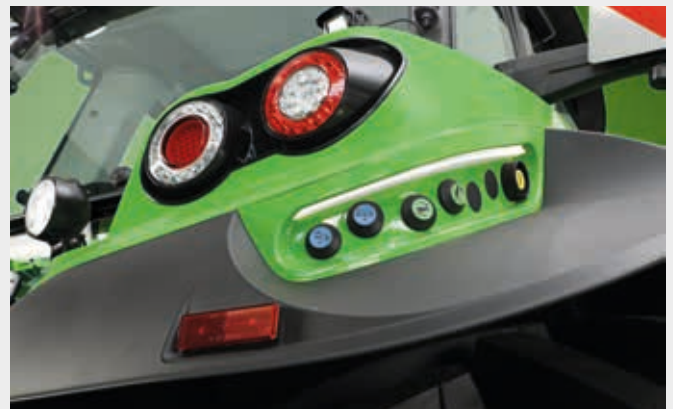
↑ Beleuchtete Tasten für die externe Bedienung des Heckkrafthebers, der Zapfwelle und eines Zusatzsteuerventils.
