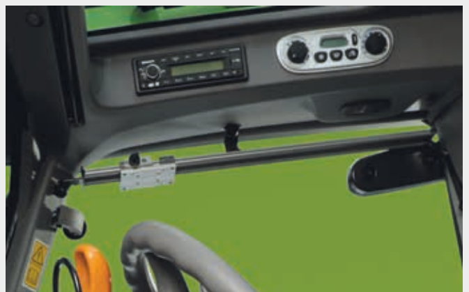
Bedienung für Radio, Klimaanlage und Beleuchtung, sowie verschiebbare Terminalhalterung.
