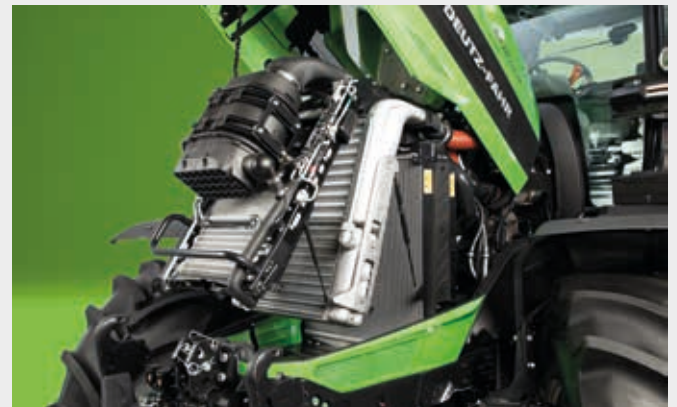
↑ Klappbares Aluminium-Kühlsystem des 6210 TTV, 6230 TTV und 6230 TTV HD mit Einhand-Entriegelung und Powercore-Luftfilter.
