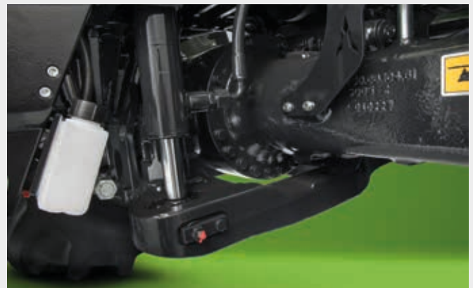
Vorderachse des 6190 TTV mit robuster Unterschwinge.
