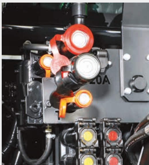
↑ Power Beyond mit flachdichtenden Kupplungen für eine saubere Verbindung.
