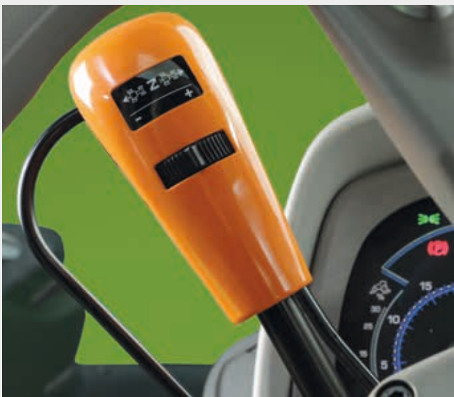
PowerShuttle mit Sense-Clutch und fünf Einstellungen des Ansprechverhaltens.
