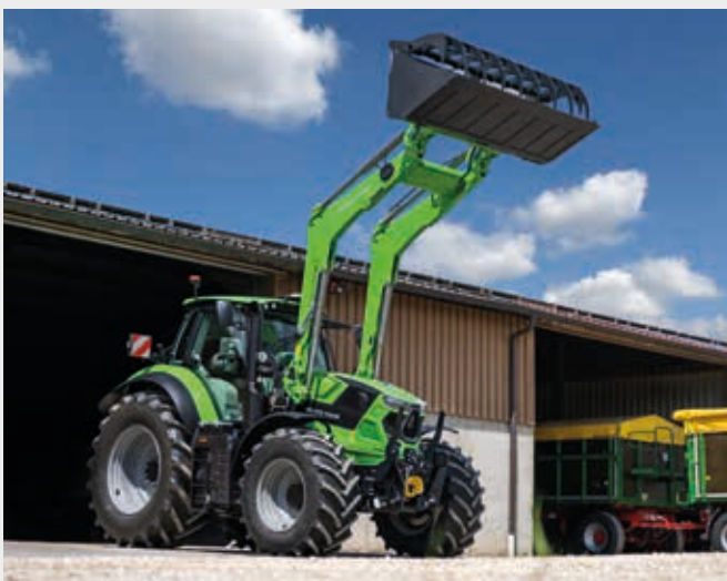
↑ Maximale Hubhöhe von 4,5 m und eine Losbrechkraft von 3.750 daN.
