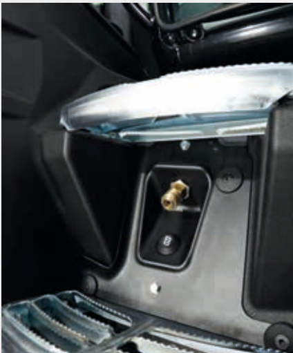
↑ Druckluftanschluss und Lichtschalter für die Aufstiegsbeleuchtung geschützt in den Aufstieg integriert.
