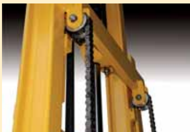
2 CATENE DI SOLLEVAMENTO 2 Lifting chains / 2 Hubketten 2 Chaines de soulèvement 2 Cadenas de levantamiento
