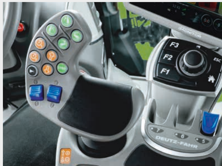
↑ Joystick ergonomique MaxCom avec boutons pour le relevage, commandes moteur et transmission, bouton de gestion des fourrières et deux distributeurs électroniques proportionnels.
