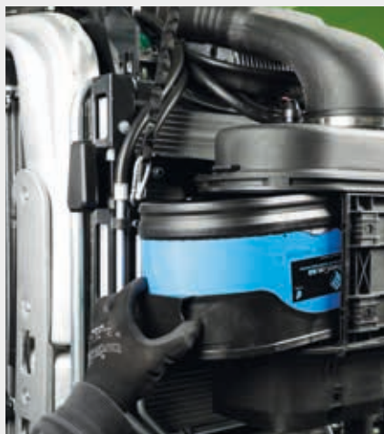
↑ Filtre à air avec unité de pré-nettoyage.
