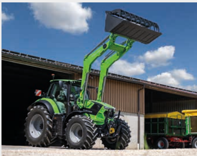
↑ Hauteur de levage maximale de 4,5 m et force d'arrachage de 3 770 daN.
