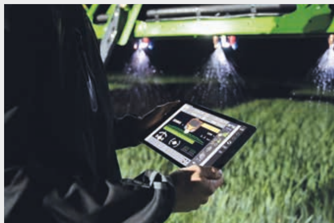
↑ Fonction XTEND, commande des outils avec ISOBUS UT via tablette à l'extérieure de la cabine.
