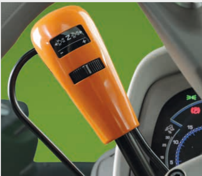
↑ Inverseur électrohydraulique avec Sense Clutch et cinq niveaux d'agressivité.
