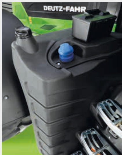
↑ Réservoir de carburant jusqu'à 505 l pour une durée de service accrue.
