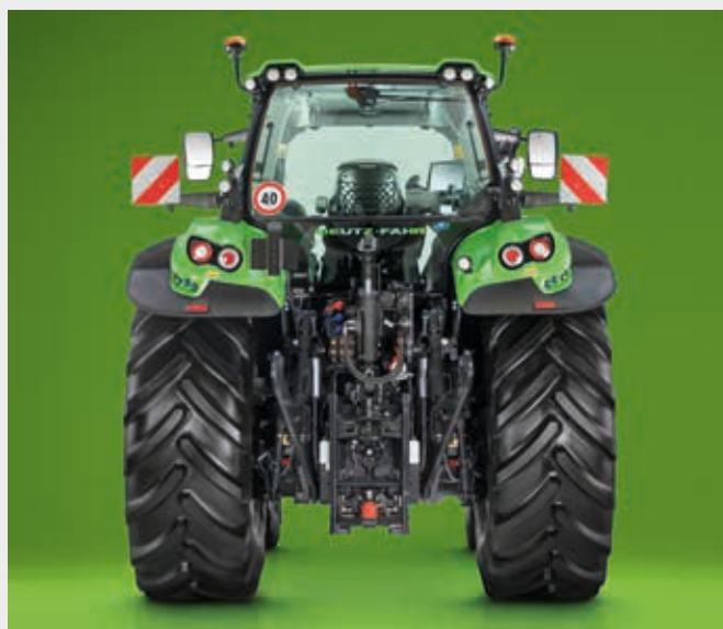
Le système « Clean Oil » fournit jusqu'à 90 litres d'huile aux outils et assure un coût d'entretien inférieur grâce à des intervalles de vidange de 2 000 heures ou 2 ans.
