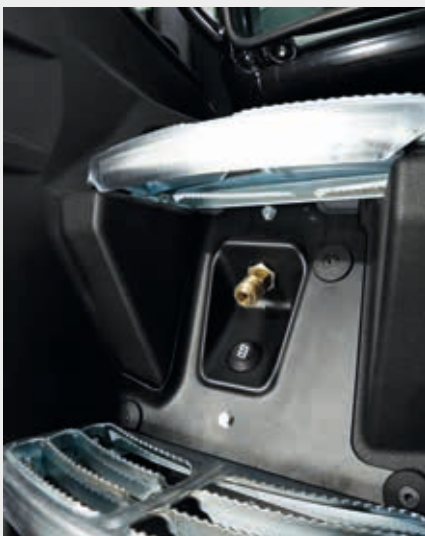
↑ Port d'alimentation en air et interrupteur d'éclairage d'entrée protégés sous les marchepieds.
