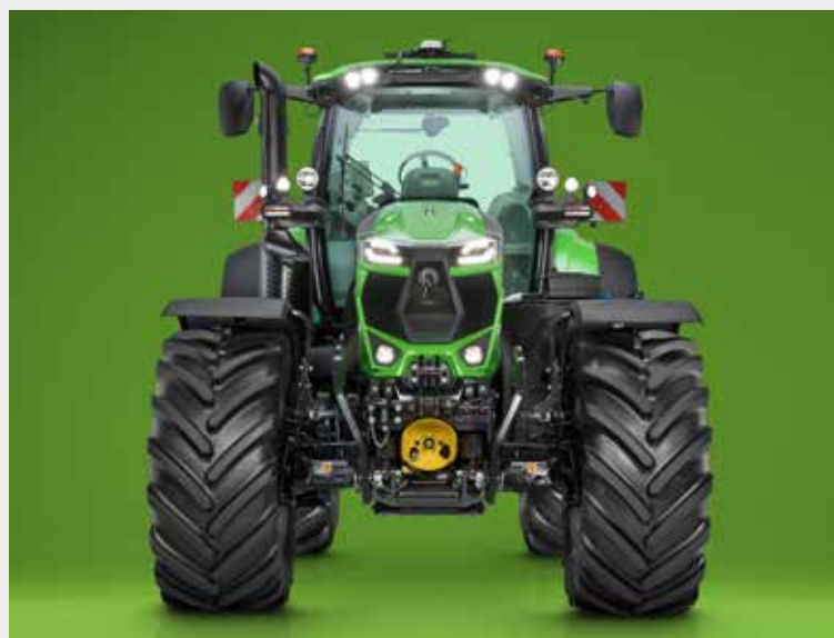
La PDF avant DualSpeed est dotée d'un embout cannelé amovible, permettant de raccorder le tracteur à des outils dotés d'arbre de transmission de tout type.
