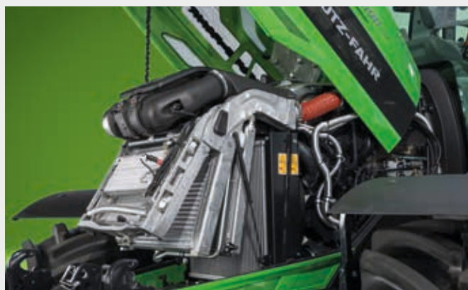
↑ Système de refroidissement en aluminium 6190 TTV avec levier et filtre à air Powercore.
