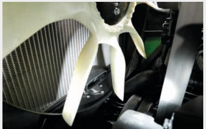
⬆ Ventilateur électronique (eVisco) avec tuyau d'aspiration pour le système de pré-nettoyage du filtre à air (élimine 95 % des grosses particules avant qu'elles n'atteignent les filtres).
