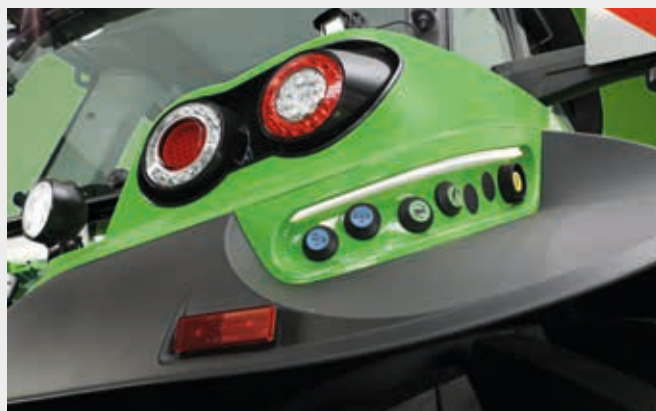
↑ Boutons-poussoirs éclairés pour la commande externe du relevage arrière, de la PDF et d'un distributeur.
