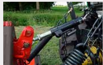
FRONTFLEX-Teleskop-Oberlenker (nur für schwenkbaren Anbaubock geeignet)
