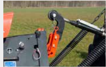
Flexibler FLEXTOP-Oberlenker (nur für starren Anbaubock geeignet)
