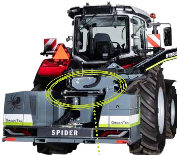
Der Arm ist am anderen Ende der Dreheinheit montiert und kann um jeweils 45° nach vorne und hinten gedreht werden. Dadurch ist der Schneidkopf stets vollständig im Sichtfeld des Fahrers.
