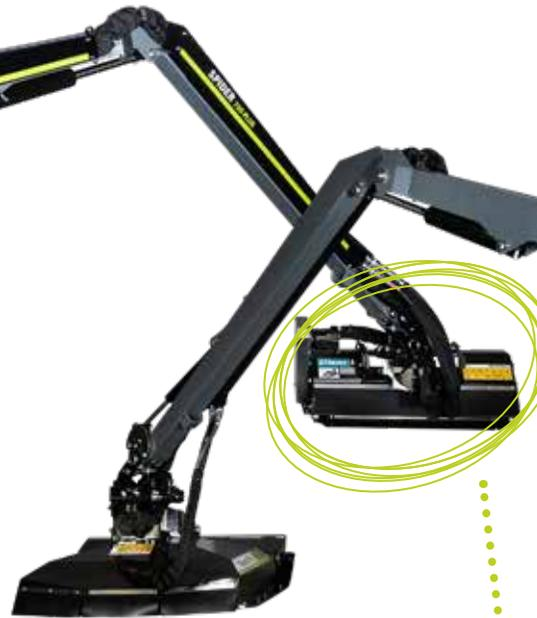
Von der Kabine aus wird der Arm von rechts nach links und nach vorn in das Sichtfeld des Fahrers bewegt.
