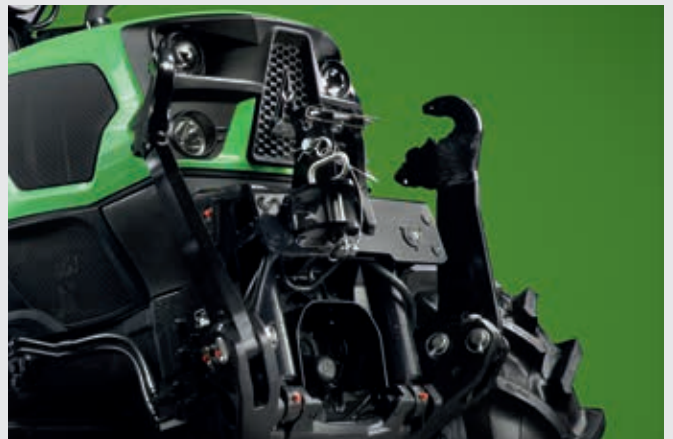
⬆️ Frontkraftheber mit einer Hubkraft von 2100 kg verfügbar.
