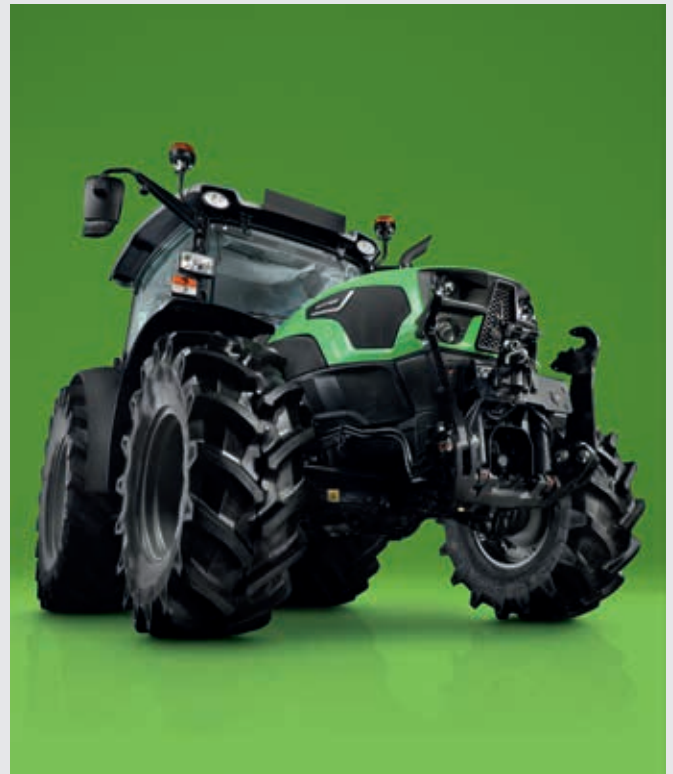
↗ Vorderachsen serienmäßig mit Radbremsen ausgestattet.
