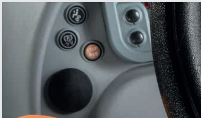
↑ Mit der Funktion Stop&Go kann der Fahrer den Traktor nur mit den Bremspedalen anfahren und anhalten.
