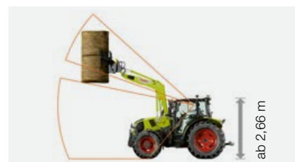
Hochdachkabine mit Glasdachluke: Durchfahrts Höhe ab 2,66 m.
