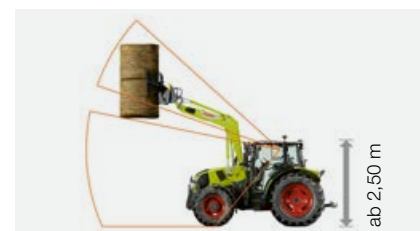
Niedrigdachkabine mit Glasdachluke: Durchfahrts Höhe ab 2,50 m.
