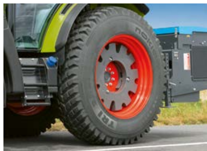
Das linke Hinterrad können Sie mit bis zu 270 kg aufballastieren, um das Gewicht des Auslegerarms auszugleichen. So sind Sie immer stabil und sicher unterwegs.
