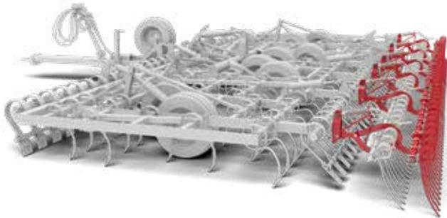
Doppel-Nachstriegel verbessert den Nivellierungs- und Bodenbearbeitungseffekt (6,25cm Zinkenabstand)
