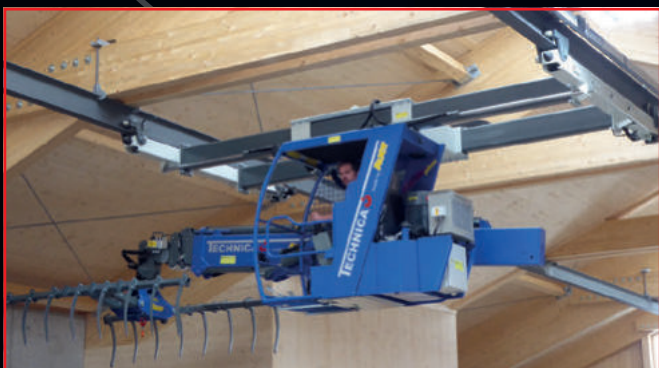
Hydr. Verschieberahmen mit Zylinder oder Kette auf deine Spurbreite angepasst.
