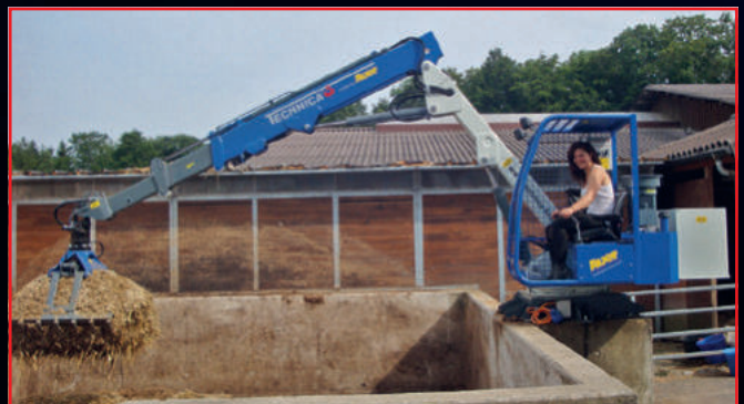
Stationär-/Mobilkrane in diversen Ausführungen, Greifer mit doppelten Laschen für Mist.
