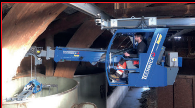
Hydr. Doppelkettenzugwinde mit gehärteter Führung und Antriebsnuss (Kamera an Greifer, Bildschirm in Kabine).
