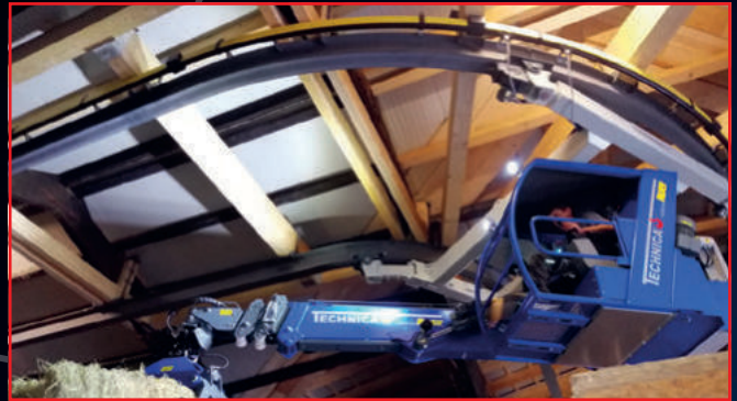
Kurvenfahrwerke sind optimale Lösungen für querliegende Gebäude.
