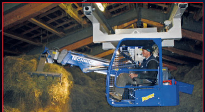
Beidseitig abgesetztes Fahrwerk unter dem Heuverteiler.
