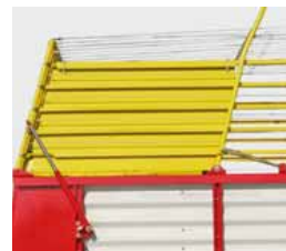
Silierbleche für Dürrfutteraufbau
