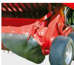
Seitliche Gummi- abdeckung für Pick-up
