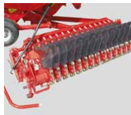
Schneidwerk seitlich ausschwenkbar
