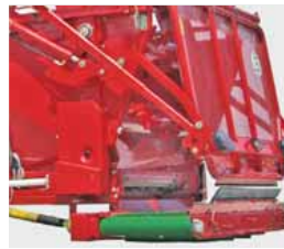
Querförderband zu Entladedosierung
