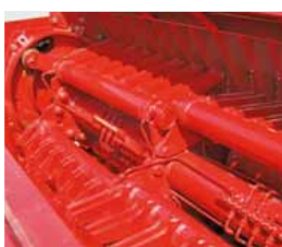
Vier Förderkämme mit Zentralschmierung
