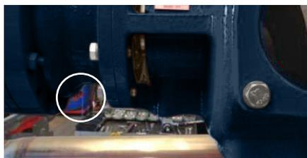
Fenêtre d'inspection – contrôle d'étanchéité
