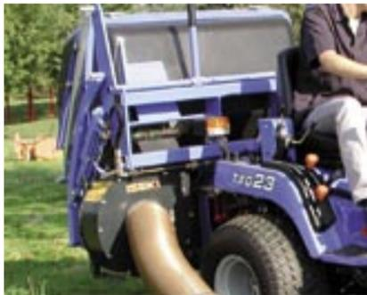
ISEKI-Grasaufnahmegeräte mit 550 Liter Behältervolumen bieten höchste Aufnahme- und Saugleistung. Optional ist eine patentierte hydraulische Hochentleerung auf 2,0 m Auskipphöhe erhältlich.
