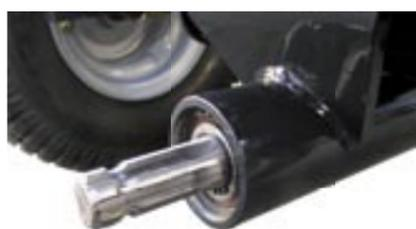
Die Frontzapfwelle wird zuverlässig und kraftvoll direkt vom Getriebe angetrieben. Der Zapfwellenstummel ist mehrfach gelagert und optimal zugänglich.
