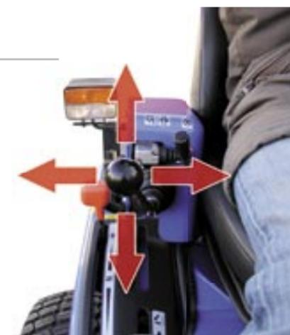
Die hydraulische Anbaugerätesteuerung erfolgt direkt neben dem Fahrersitz mit nur einem Hebel.
