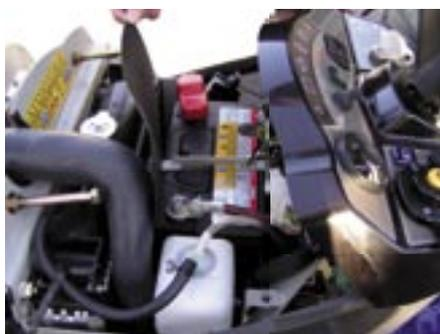
Die Batterie der ISEKI TXG-Modelle ist direkt unter der Motorhaube erreichbar. Wussten Sie, dass Batterien im harten Wintereinsatz besonders stark beansprucht werden und daher regelmäßig der Flüssigkeitsstand geprüft werden muss?
