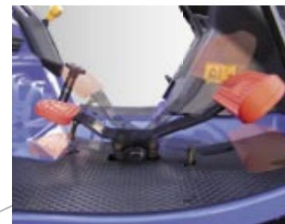
Stufenlose Fahrgeschwindigkeit durch das Hydrostatpedal.
