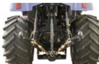
Mittels einer Senkdrossel kann die Absenkgeschwindigkeit stufenlos eingestellt werden.
