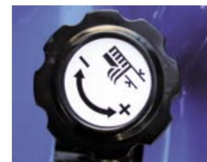
Mittels dieses Einstellrades bestimmen Sie die Schnitthöhe des Zwischenachsmähwerkes vom Fahrersitz aus! Ohne abzusteigen können Sie die Schnittstufen millimetergenau bestimmen.
