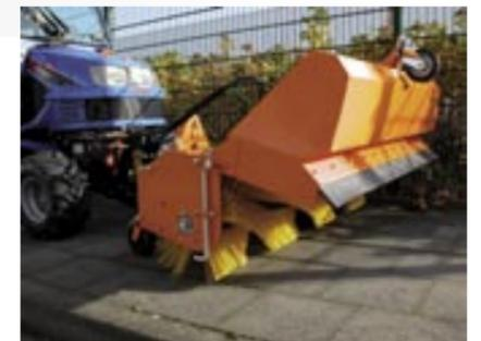
ISEKI-Frontkehrmaschinen mit 130 cm oder 150 cm Arbeitsbreite kehren Schmutz und Schnee zuverlässig. Die Kkehrbürste wird über einen kraftvollen Schwenkzylinder vom Fahrersitz aus verstellt. Ein zusätzlicher Schmutzbehälter macht Ihren Kehreinsatz zum Vergnügen.
