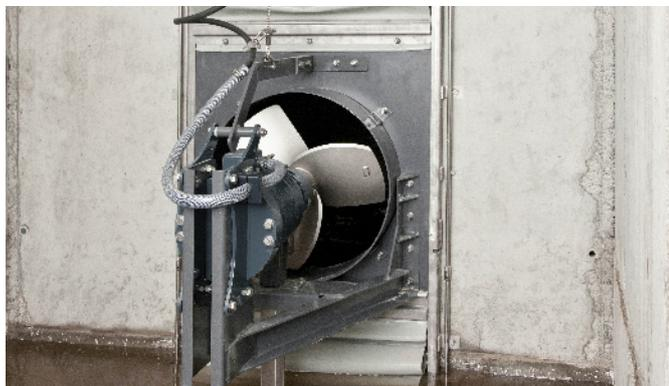
Le modèle stationnaire et réglable en hauteur convient pour les systèmes de canaux et de slalom. Le brasseur est monté directement sur la paroi transversale avec une ouverture de 800 mm. Le moteur immergé est disponible soit en acier inox avec une puissance de 20 CV (15 kW) ou en fonte grise avec une puissance de 20 CV (15 kW).
