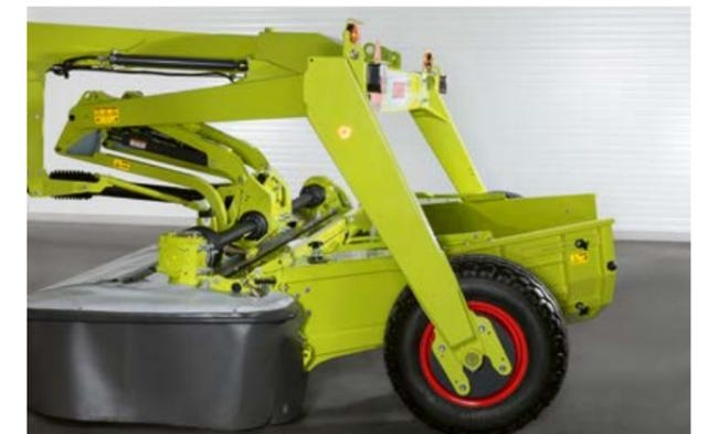
Pendeln in Querrichtung. Gemeinsam mit der PROFIL Kinematik, dem bodennahen Balkendrehpunkt und der hydropneumatischen Entlastung ACTIVE FLOAT wird eine ideale Boden Anpassung sichergestellt.
