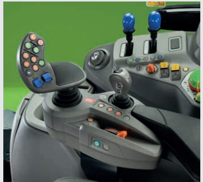
↑ Les molettes du joystick MaxCom et deux leviers mécaniques commandent les distributeurs arrière, tandis que le levier en croix peut être utilisé pour commander le chargeur frontal.
