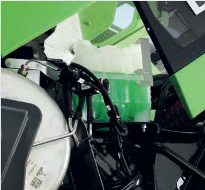
↑ Réservoir d'eau avec indicateur de niveau en acier.
