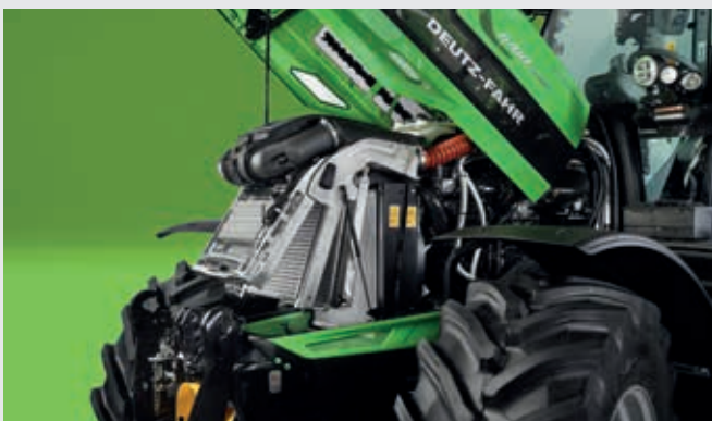
↑ Système de refroidissement en aluminium 6160.4 - 6190 avec levier d'accès à une main et filtre à air Powercore avec système de pré-nettoyage cyclone.
