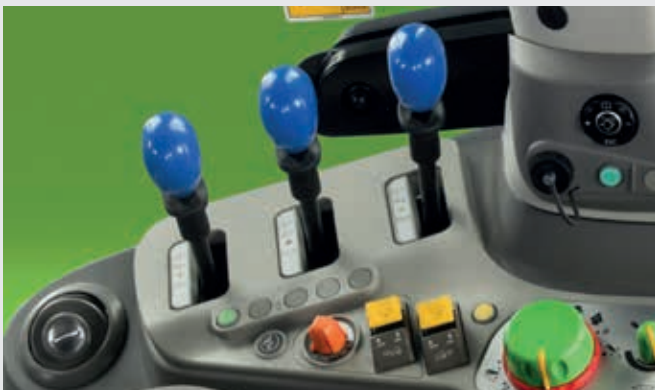
↑ Jusqu'à 4 distributeurs mécaniques avec commandes ergonomiques à un levier.
