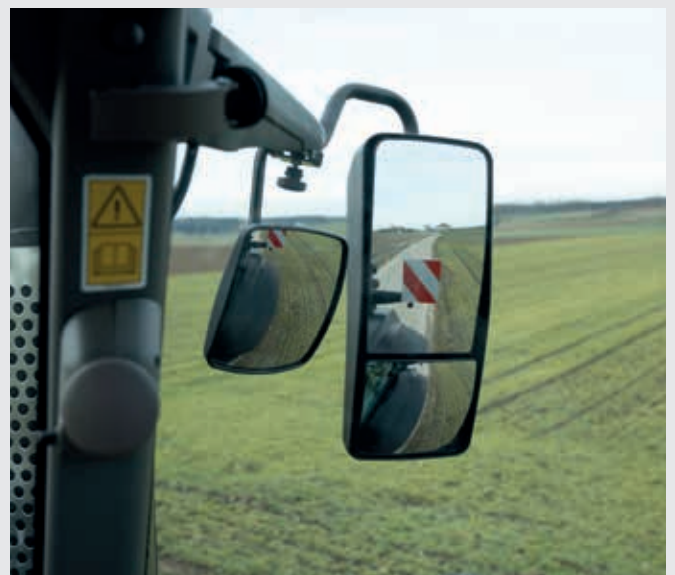
Les nouveaux rétroviseurs ont augmenté de 65% et garantissent ainsi une excellente visibilité arrière.
