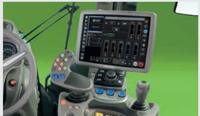
↑ Distributeurs électriques avec confortables éléments de commande électroniques.
