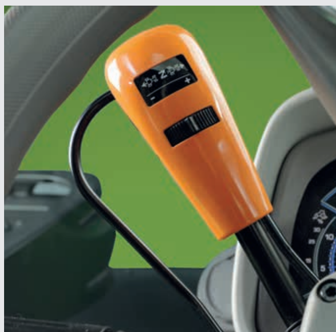
Levier d'inverseur hydraulique ergonomique avec molette de réglage SenseClutch.
