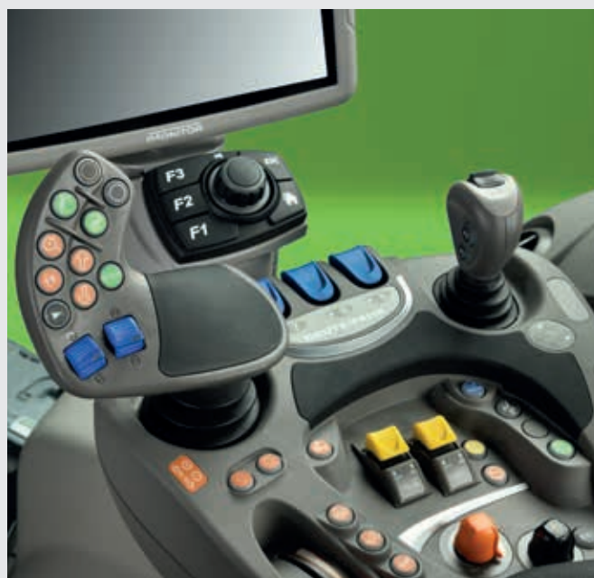
↑ Pour commander les distributeurs électriques, l'opérateur peut recourir aux commandes bleues du bout des doigts, au petit joystick ou aux pratiques molettes du joystick MaxCom.
