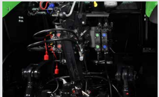
↑ Grand confort combiné à la facilité d'utilisation : configuration hydraulique mixte avec deux distributeurs électriques et deux distributeurs mécaniques.
