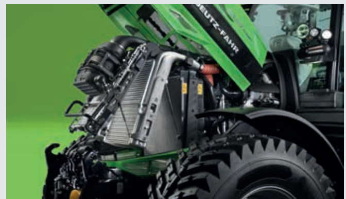
↑ Système de refroidissement en aluminium du 6210 et du 6230 avec levier d'accès à une main et filtre à air Powercore avec système de pré-nettoyage cyclone en option.
