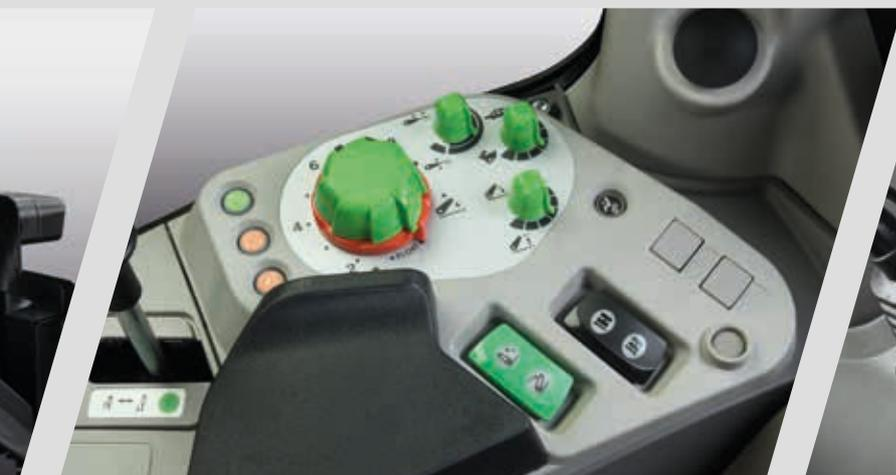
> Contrôle précis de l'effort et de la position grâce au relevage arrière électronique.
