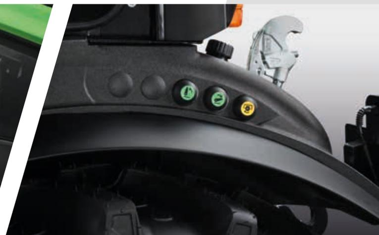
> Boutons extérieurs pour le relevage arrière et la PDF pour faciliter les manœuvres d'attelage.
