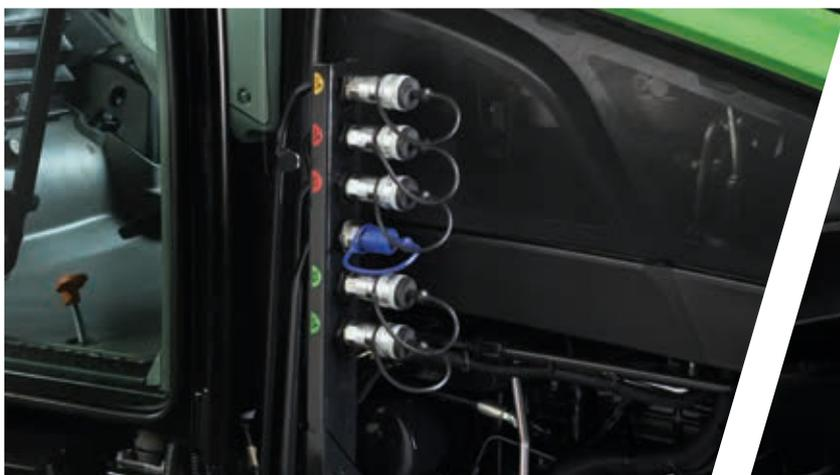
> Jusqu'à 5 voies hydrauliques ventrales.
