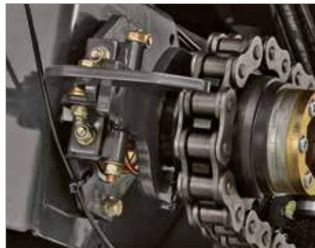
**5. Mechanische Rotorentkopplung**
