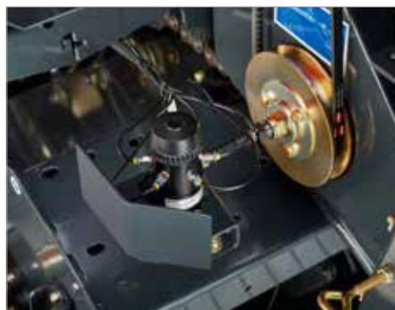
9. Automatische kontinuierliche (BEKA-MAX) Kettenschmierung
