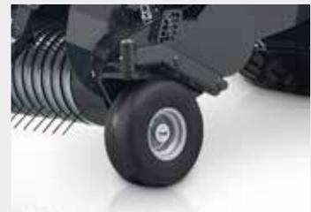
Nachlaufende Pick-up Tasträder mit Nonstop-Luftkammer-Reifen
