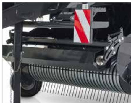
**5.** Federbelastetes Pick-up Prallblech und schwerer Rollenniederhalter (Ø 217 mm) für bessere Vorverdichtung und optimierten Gutfluss
