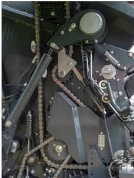
10. Heavy duty-Antrieb mit verschleißfesten, großdimensionierten Ketten
