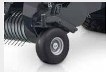
Nachlaufende Pick-up Tasträder mit Nonstop-Luftkammer-Reifen
