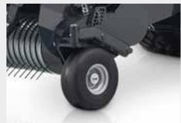
Nachlaufende Pick-up Tasträder mit Nonstop-Luftkammer-Reifen
