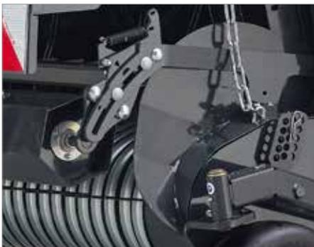
**4. Federbelastetes Pick-up Prallblech und schwerer Rollenniederhalter (Ø 217 mm) für bessere Vorverdrichtung und optimierten Gutfluss**
