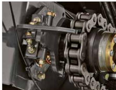
4. Mechanische Rotorentkopplung
