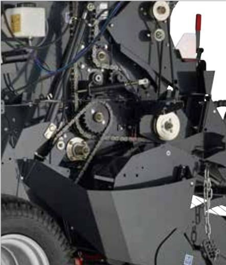
1. Robuster Antrieb mit hochwertigen IWIS-Ketten
