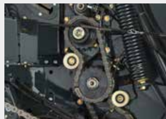
Double entraînement de la nappe de courroies
