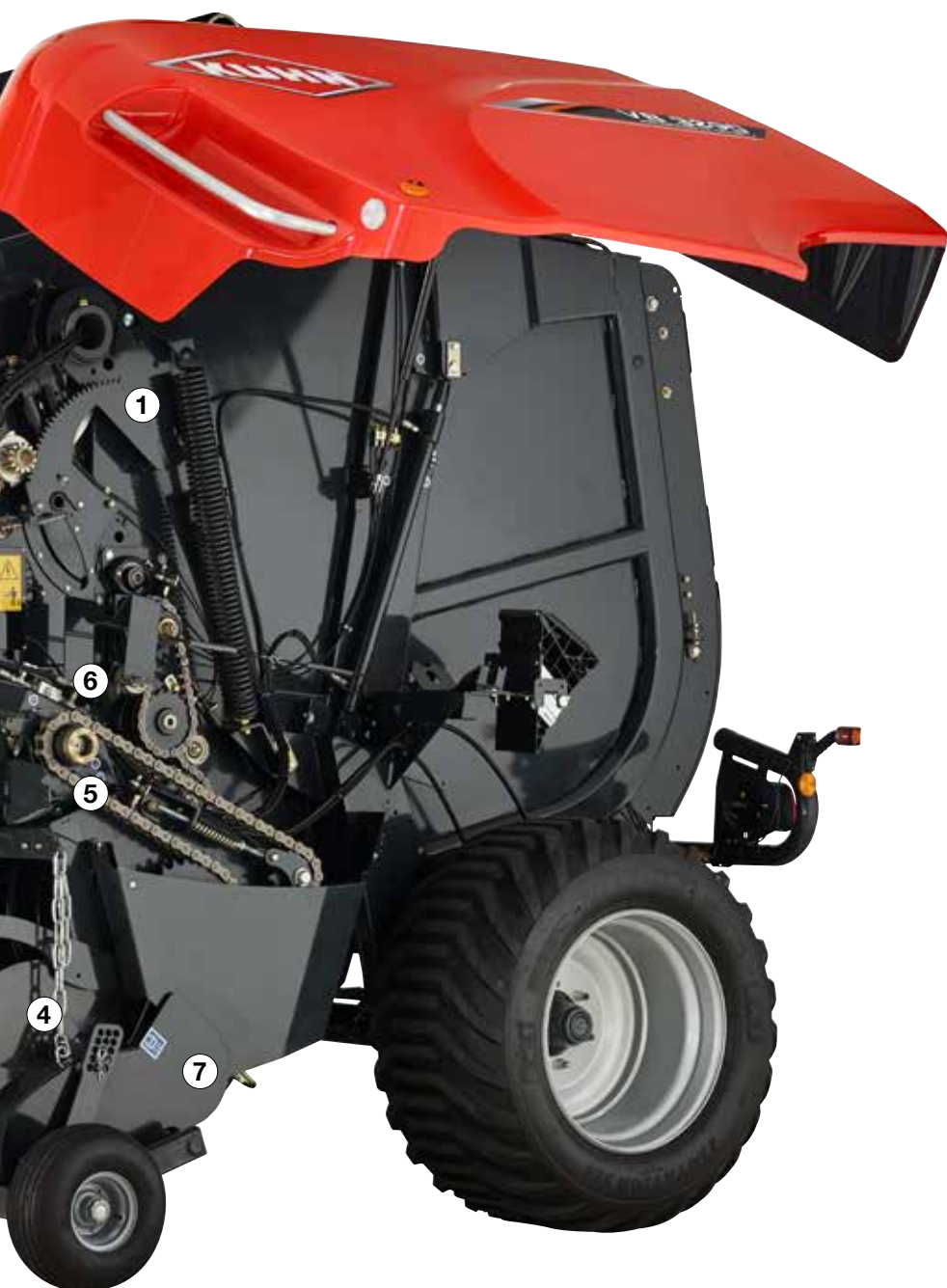
Double entraînement de la nappe de courroies
