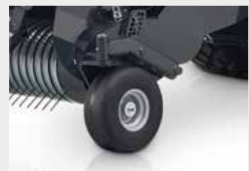
Roues de jauge du pick-up pivotantes et semi-pneumatiques
