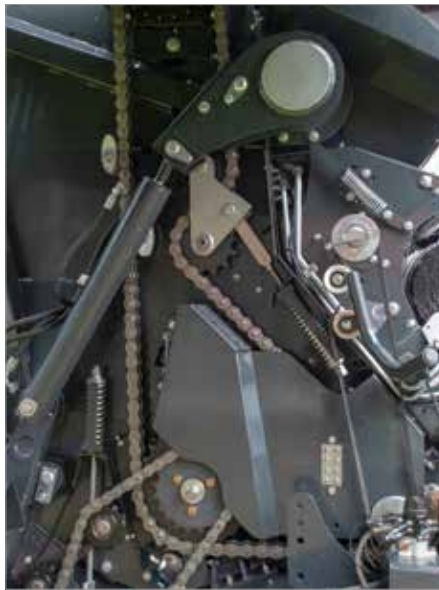
10. La transmission robuste est dotée de chaînes surdimensionnées résistantes à l'usure
