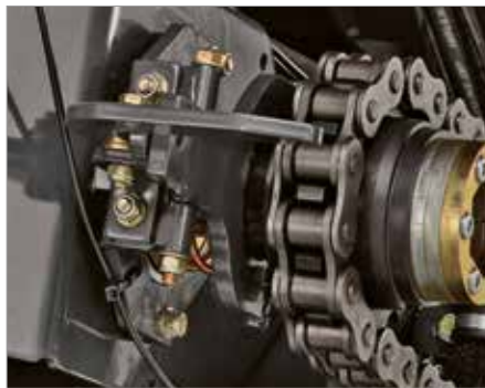
5. Débrayage mécanique du rotor
