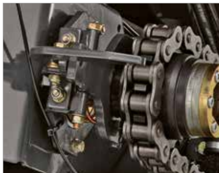
4. Débrayage mécanique du rotor
