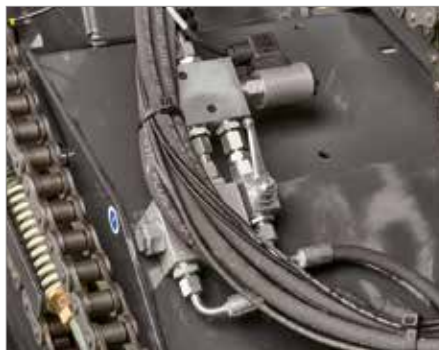
6. Contrôle de couteau / trappe escamotable DROPFLOOR séparé, pilotés depuis la cabine
