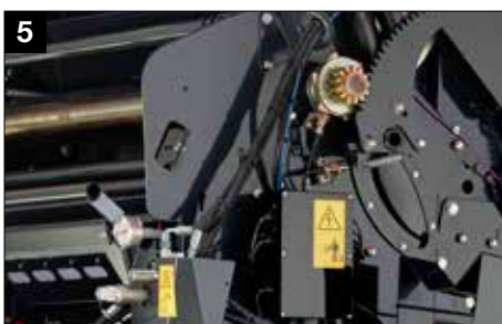
Proportionalventil für die Dichtregelung aus der Fahrerkabine
