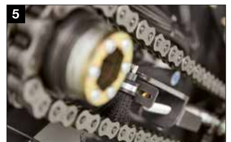
Stabile und breite Ölbürsten für optimale Kettenschmierung
