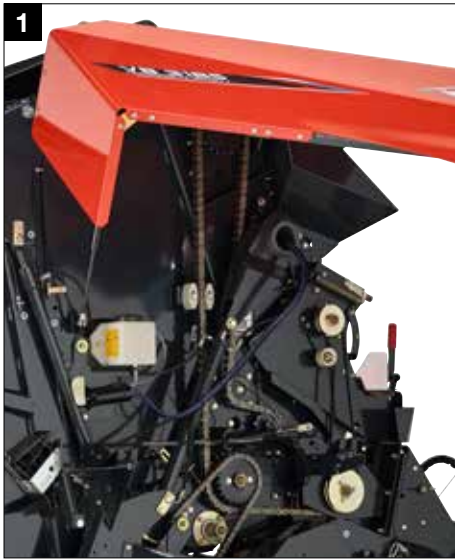
Robuster Antrieb mit hochwertigen IWIS-Ketten
