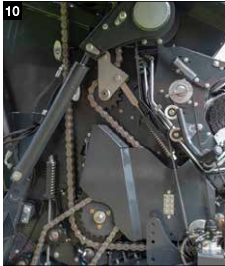
10 Robuster Antrieb mit verschleißfesten, überdimensionierten Ketten
