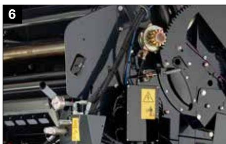
Proportionalventil für die Dichtregelung aus der Fahrerkabine
