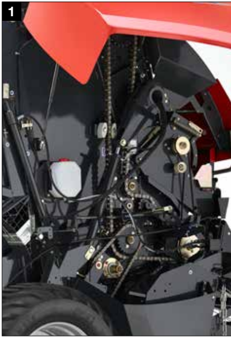
Robuster Antrieb mit hochwertigen IWS-Ketten
