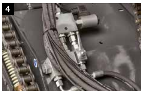
Separate Messerabschaltung/ SCHNEIDBODENABSENKUNG vom Fahrersitz aus
