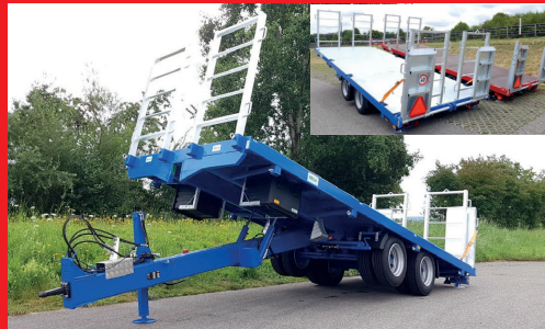
TA-S 160 / 190 / 210 - 16 / 19 / 21 To. 650 / 700 / 750 / 820 x 250 / 255 cm hydr. Heckabsenkung / basculante
