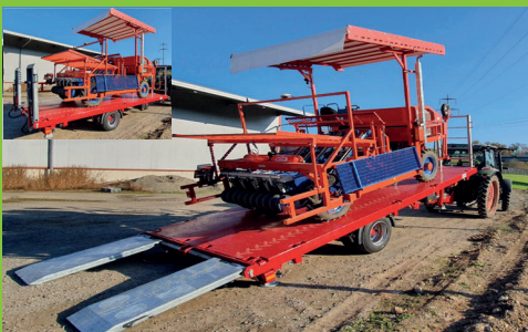
EA-S 80 / 100 / 120 - 8 / 10 / 12 To. 500 / 550 / 600 x 250 / 255 cm hydr. Heckabsenkung / basculante
