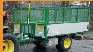
TA 140 / 160 / 190 / 210 - 14 / 16 / 19 / 21 To. 500 / 600 / 650 / 700 / 750 / 820 x 250 / 255 cm mit Bordwänden und Rampen / avec ridelles et rampes
