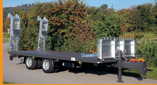
TA-S 160 / 190 / 210 - 16 / 19 / 21 To. 650 / 700 / 750 / 820 x 250 / 255 cm hydr. Heckabsenkung / basculante
