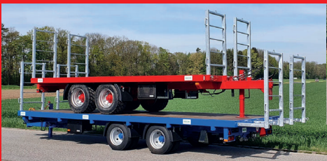
EA-S 80 / 100 / 120 - 8 / 10 / 12 To. 500 / 550 / 600 x 250 / 255 cm hydr. Heckabsenkung / basculante
