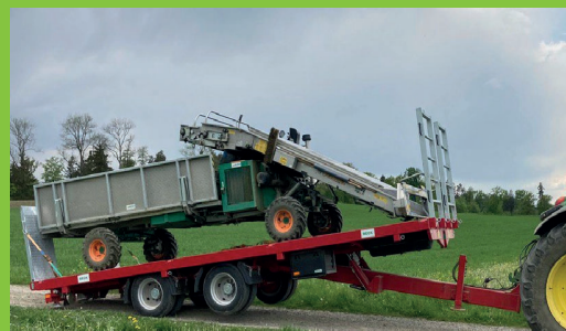
TA-S 160 / 190 / 210 - 16 / 19 / 21 To. 650 / 700 / 750 / 820 x 250 / 255 cm hydr. Heckabsenkung / basculante
