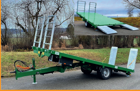
EA-S 80 / 100 / 120 - 8 / 10 / 12 To. 500 / 550 / 600 x 250 / 255 cm hydr. Heckabsenkung / basculante
