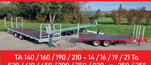
TA-S 160 / 190 / 210 - 16 / 19 / 21 To. 650 / 700 / 750 / 820 x 250 / 255 cm hydr. Heckabsenkung / basculante
