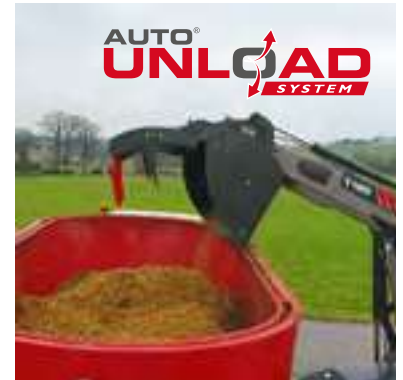
Synchronisation der Bewegungen von Schaufel und Greifer
