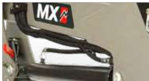
Die Hydraulikschläuche und der Kabelbaum aus Polyurethan passen diskret unter den Arm des Frontladers. Sie sind gut geschützt, bleiben sauber und leicht zugänglich.
