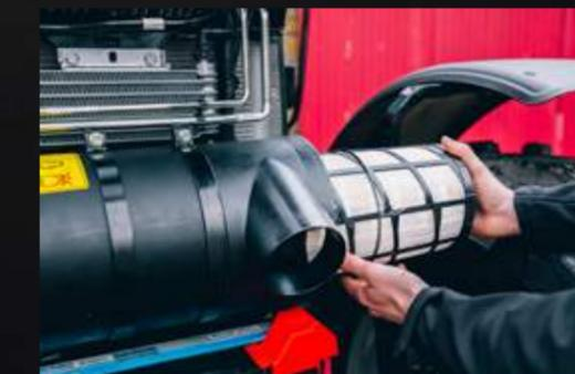
Der Luftfilter des Motors ist bequem zugänglich und leicht zu reinigen.
