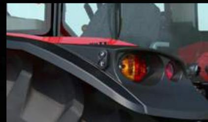
Externe elektrische Taster am Kottflügel ermöglichen das einfache Anheben/Absenken des Heckkrafthebers, wenn Heckenbaugeräte an- oder abgekoppelt werden.
