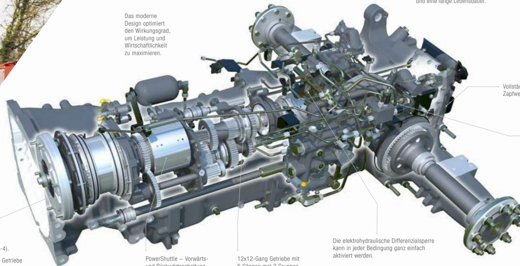
Die hydraulische Zapfwellenkupplung gewährleistet eine einfache Bedienung und eine lange Lebensdauer.
