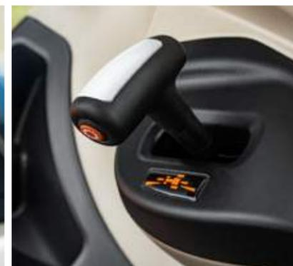
Der exklusive **PowerControl**-Hebel ermöglicht die bequeme und einfache Bedienung von drei Funktionen. Der Fahrer kann die Fahrtrichtung wechseln (Vorwärts/Rückwärts) oder den Leerlauf anwählen und dabei die rechte Hand zur Bedienung des Heckkrafthebers oder Hydraulikgeräts frei behalten.
