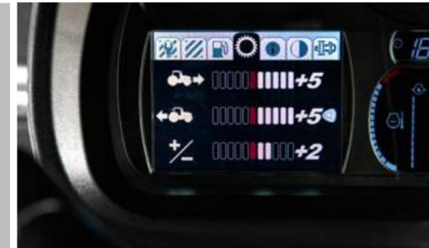
Die **zusätzlichen Kriechgänge** ermöglichen bei Arbeiten, die besonders langsame Geschwindigkeiten erfordern, eine präzise Regelung der Vorwärtsgeschwindigkeit bis zur niedrigen Geschwindigkeit von 100 m/h.
