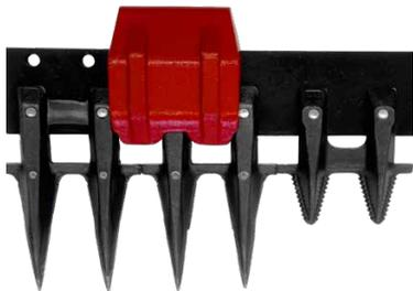
«Klemmsohlen» führen durch die Positionierung unter dem Messerbalken, nahe am «Schnittpunkt» auch in kuperem Gelände optimal. Die zuverlässige Klemmverbindung ermöglicht das Anbringen mehrerer Einheiten über die gesamte Breite – unabhängig von Lochbildern im Balkenblatt.
