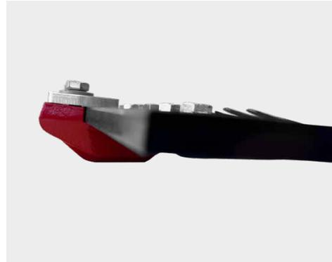
Position der Klemmsohle ist unter dem Messerbalken; nicht verstellbar für Stoppelhöhe von ca. 6 cm
