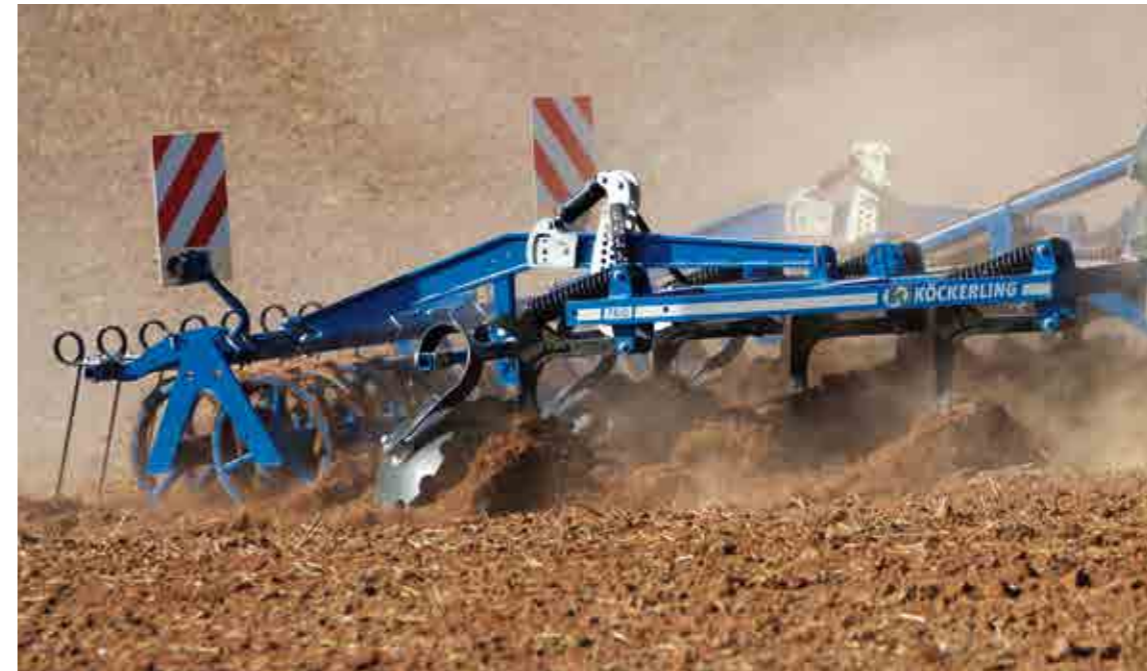
Trio 300 mit Doppel-STS-Walze, Scheibennivellator und Steinsicherung
