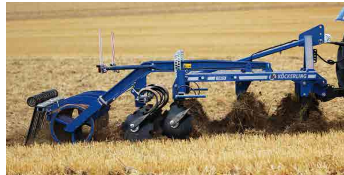
Trio 300 mit STS-Walze, Scheibennivellator ohne Steinsicherung
