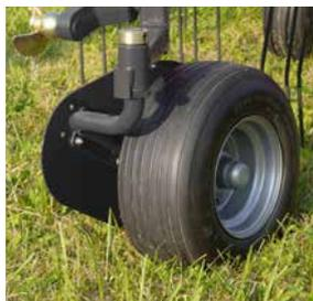
Für eine optimale Bodenpassung können die Schwader optional mit einem zusätzlichen Stützrad ausgestattet werden.
