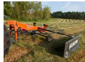
Der Dreipunkt-Nachlaufbock hat einen extrem großen Schwenkbereich und ermöglicht so ein optimales Nachlaufverhalten, auch in engen Kurven.
