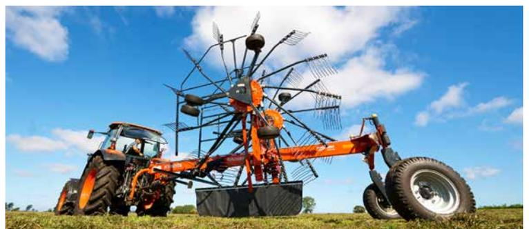
Kubota Mittelschwader lassen sich für den Transport bequem vom Schleppersitz aus hydraulisch in Transportposition bringen.
