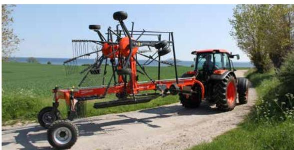
Für eine reduzierte Transport- und Abstellhöhe lassen sich beim RA2076 die Zinkenarme demontieren. Das Schwad Tuch klappt automatisch ein.
