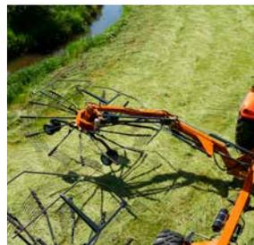
Die Arbeitsbreite lässt sich von 9,80 bis 15,00 m hydraulisch verstellen
