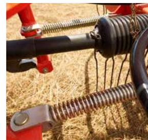
Schwingungsdämpfer für ein exzellentes Nachlaufverhalten.
