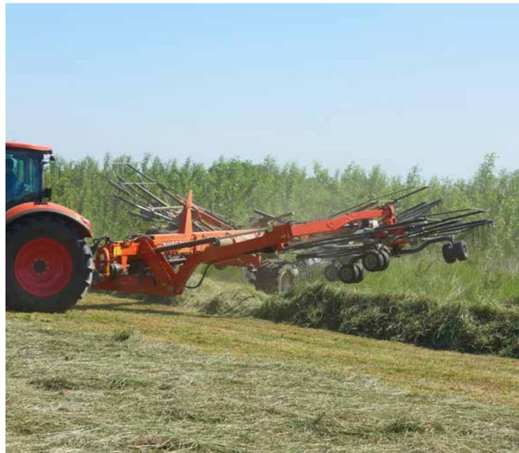
Werden schon bearbeitete Flächen überfahren, heben die einzelnen Kreisel automatisch an diesen Stellen aus bzw. setzen vor nicht bearbeiteten Flächen rechtzeitig wieder ein.
