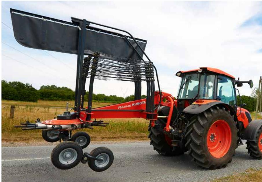
Die stabilen Schutzbügel werden nahe am Hauptrahmen hoch geschwenkt und automatisch verriegelt. Das Schwadtuch selbst ist drehbar aufgehängt, damit es in Transportstellung nach unten pendeln kann.
