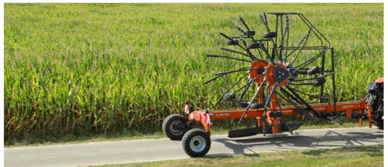
Eine Arbeitsbreite von 9,00 m und eine Transporthöhe unter 4,00 m wird erreicht ohne die Zinken zu entfernen.
