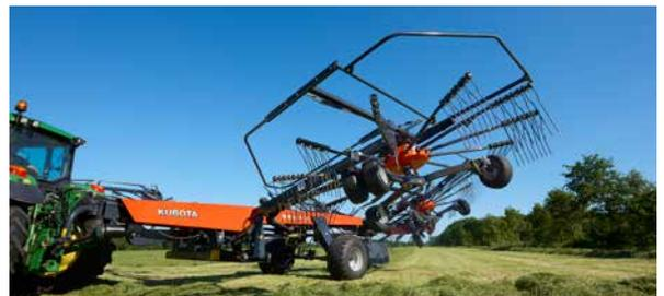
Große Aushubhöhe der Rotoren. Dies ist gerade bei großvolumigen Schwaden von Vorteil.
