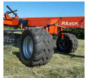
Für eine verbesserte Nachlaufefigenschaft kann der RA4515 optional mit einer hydraulisch lenkbaren Achse ausgestattet werden.
