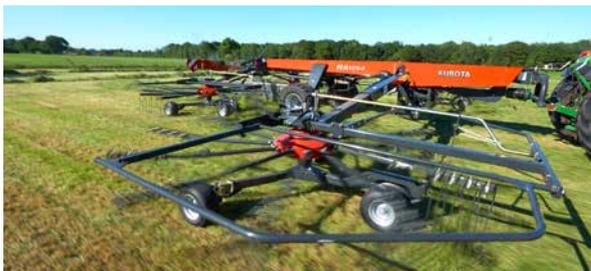
Die Arbeitsbreite kann von 10,00 – 12,50 m hydraulisch über die beiden vorderen Kreisel eingestellt werden.
