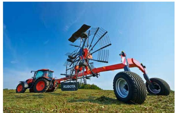
Das aktiv gesteuerte Fahrwerk sichert einen spurtreuen Nachlauf.
