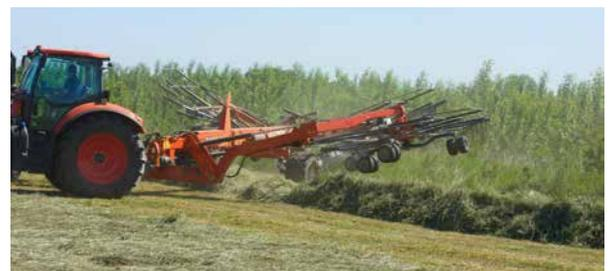
Die maximale Aushubhöhe am Vorgewende ist enorm. Bei Bedarf kann die Hubhöhe am Vorgewende individuell eingestellt werden.
