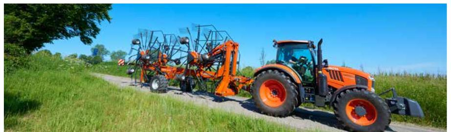
Trotz einem Kreiseldurchmesser von 3,85 m bleibt die Maschine in der Gesamthöhe unter 4,00 m! Die Zinkenarme müssen dafür nicht demontiert werden.
