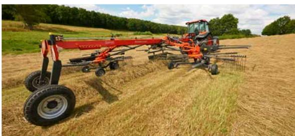
Die VARIO-Baureihe ermöglicht das Ablegen von zwei Einzelschwaden.
