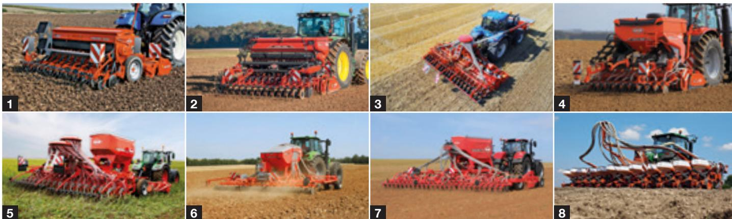
1. Anbaudrillmaschinen 2. Aufbaudrillmaschinen 3. Fronttank-Drillmaschinen 4. Pneumatische-Aufbaudrillmaschinen 5. Direktsaatgeräte 6. Zinkensätechnik 7. Mulchsaattechnik 8. Einzelkorntrossat
