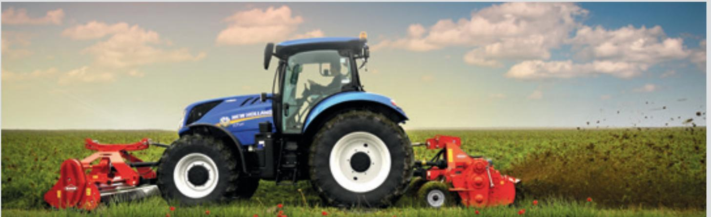
Für Arbeiten in sehr dichten Pflanzenbeständen kann die Rotorfräse EL BIOMULCH in Kombination mit dem Fronmulchgerät BP 305 PRO eingesetzt werden. So können auch bereits hochgewachsene Zwischenfrüchte perfekt eingearbeitet werden.
