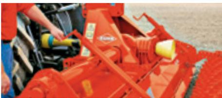
Die zweiteilige Haube und damit der Krümeleffekt ist einfach über eine Kurbel vorne an der Rotorfräse zu verstellen. So bekommen Sie keine Probleme, wenn eine Walze und Drillmaschine angebaut sind. Der robuste Aufbau der Gelenke und Hauben sorgt für eine längere Lebensdauer. An der Rotorfräse EL 402 R-600 kann diese Einstellung hydraulisch von der Traktorkabine aus während der Arbeit erfolgen.
