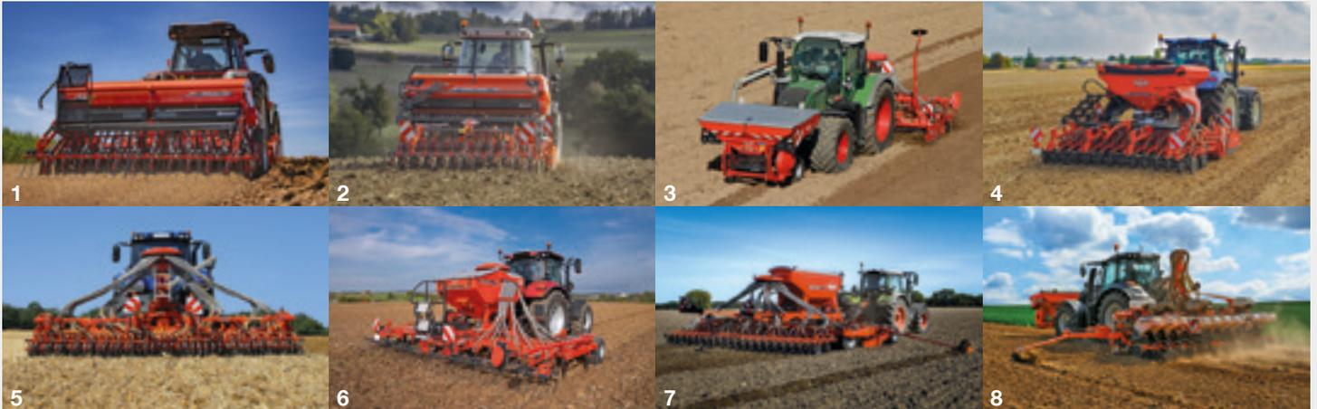
1. Mechanische Anbaudrillmaschinen - 2. Mechanische Aufbaudrillmaschinen - 3. Drillmaschinen mit Fronttank - 4. Pneumatische Aufbaudrillmaschinen - 5. Klappbare pneumatische Drillmaschinen - 6. Anbau-Mulchsaatmaschinen - 7. Gezogene Universaldrillmaschinen - 8. Einzelkornsämaschinen
