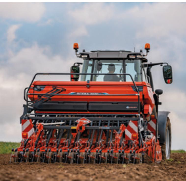
DÉCOUVREZ L'EFFET ÉLECTRIQUE. Le semoir mécanique SITERA e possède une distribution animée par entraînement électrique. Il est possible de moduler la dose manuellement ou automatiquement par GPS via un terminal ISOBUS (avec fonction TC-GEO).
