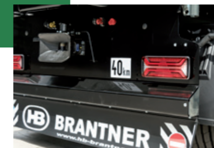
Beleuchtung serienmäßig mit Agriled Voll-LED Rückleuchte mit Widerstand für Blinker
