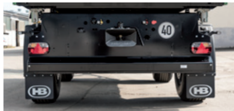
Multi-Point Beleuchtung mit Kotspritzgummi für Kotflügel
