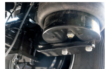
verstärkte Lenkfeder für optimale Standsicherheit und Geländegängigkeit
