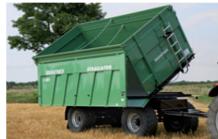
glatte Innenwände das konische Plateau und die absolut glatten Innenwände lassen das Ladegut leicht abrutschen
