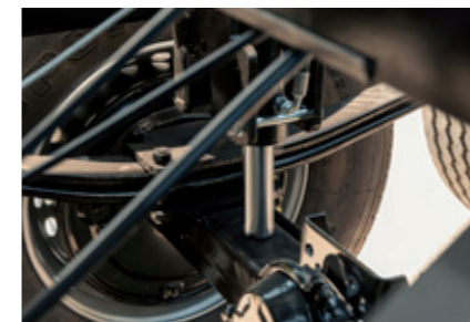
hydraulische Hinterachsabstützung serienmäßig für optimalen Federungskomfort
