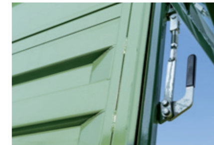
Metall-Labyrinthdichtung am Ecksteher für hintere Bord- und Aufsatzwände
