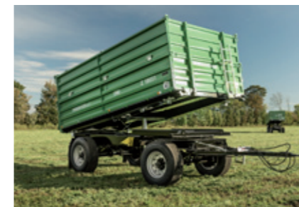
Z 18051 AKTION das Einstiegsmodell in bewährter Brantner-Qualität mit serienmäßigem Doppel-C-Pressprofilrahmen
