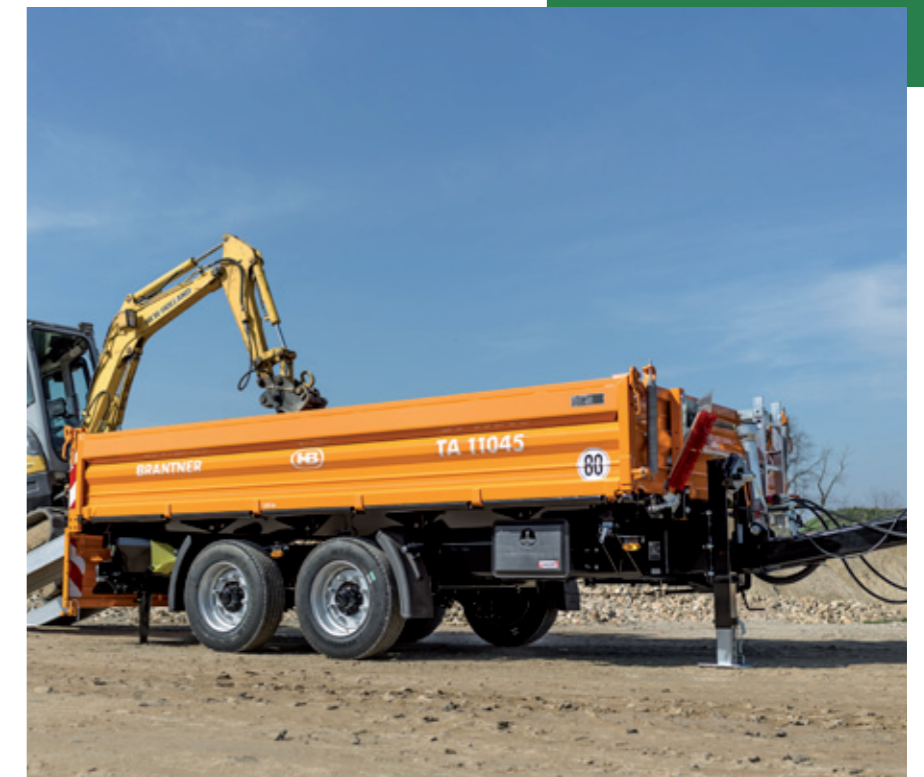
TA 11045 Tieflader der Tieflader mit Einschiebmöglichkeit von optional erhältlichen Laderampen und Abstützungen
