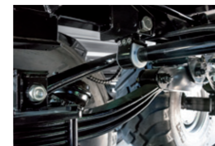
Federnstabilisator optional erhältlich, für Lenkachsen empfohlen
