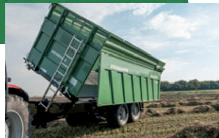
Pendelwand pendelbar gelagerte Stabilatorwände links und rechts, einfach zu öffnen
