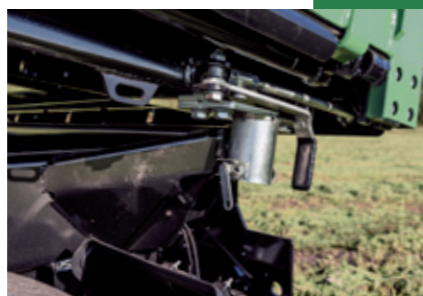
Kipplagerungen weit außen liegend für noch mehr Standicherheit
