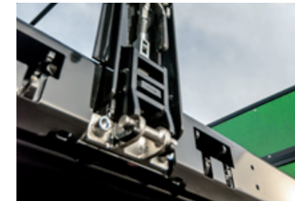
werkzeuglos abnehmbarer Mittelsteher auf Wunsch hilfreich beim Beladen mit Kisten oder Paletten
