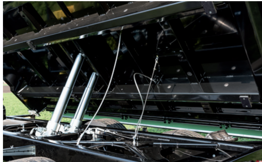
Trapezkipprahmen nach LKW Bauart inkl. Versteifungs- rippen
