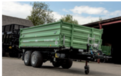
TA 8045 XXL mit Auflaufbremse und 500 mm Aufsatzwänden
