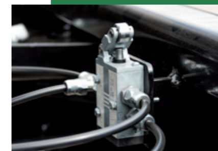
automatische Absenkung beim Abkippvorgang
