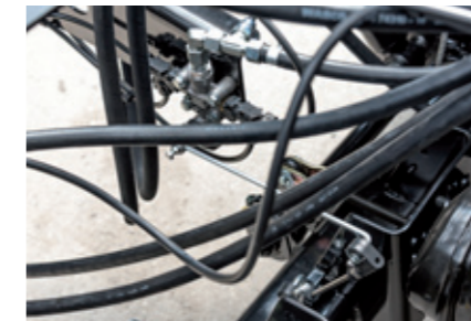
pneumatischer ALB sorgt für eine passende Einstellung der Bremskraft
