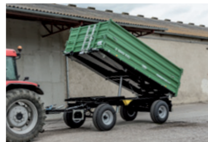
Z 8045 XXL mit Auflaufbremse und Aufsatzwänden 500 mm
