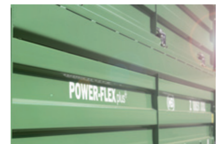
Bordwandversteifungen aus 6 mm Stahlblech mit Kastenprofil fix verschweißt
