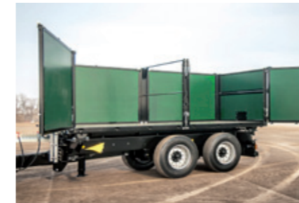
Portaltür serienmäßige Portaltür links (optional auch rechts möglich), pendelbar gelagert
