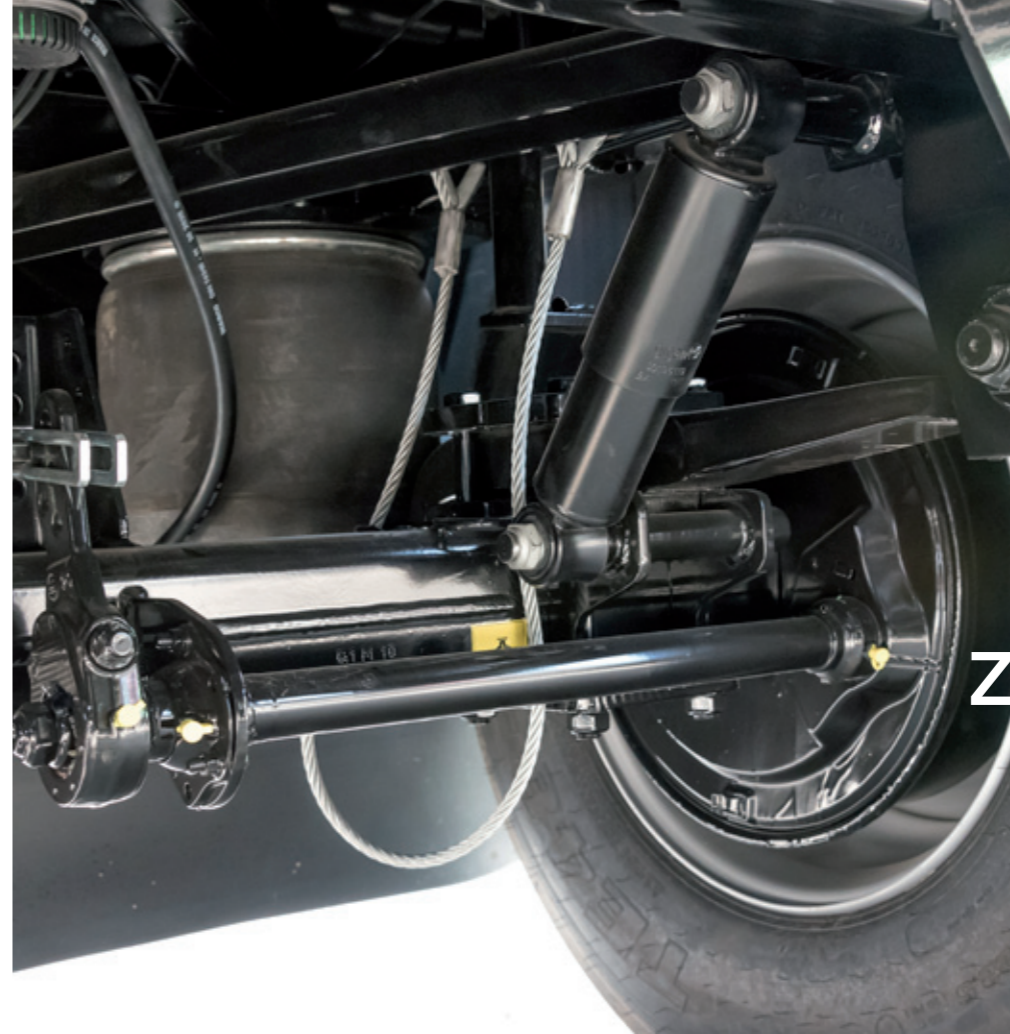
Standard-LKW-Luftfederung mit Stoßdämpfer
