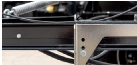
U-Profil mit 100 mm für 2 x 26 to
