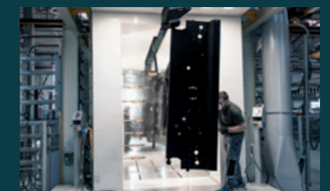
Pulver automatische Pulverbeschichtung
