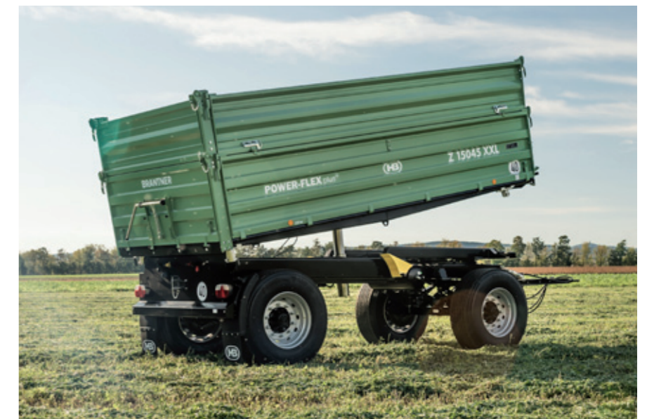
Z 15045 XXL AKTION Optional: PROFI-Paket mit 2 Kippzylinder, Bordwandversteifung, Bordwandhebefedern und 5 mm Stahlblechboden
