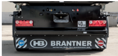
Europoint II Beleuchtung mit Kotspritzgummi über gesamte Breite
