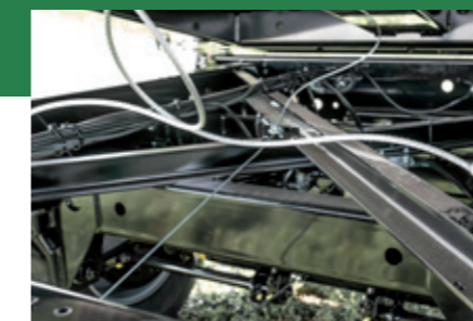
Kreuzversteifung verstärkte Verwindungssteifigkeit
