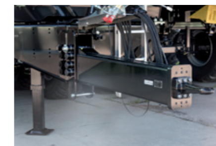
höhenverstellbares Zugrohr gefertigt aus Doppel-C-Pressprofilen, als Oben- und Untenanhängung
