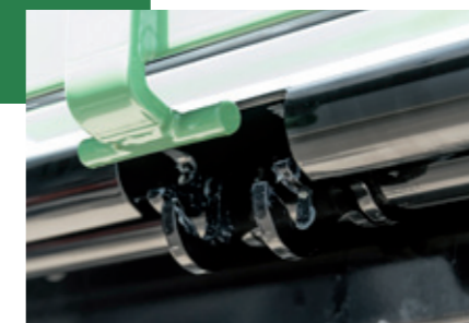
Bordwandscharniere ab 5 m Plateaulänge mit doppelter Verriegelung
