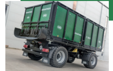
Rutsche zum optimalen Entladen von sensiblen Schüttgut (z. B. Kartoffel)
