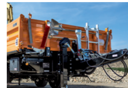
TA 13045 Tieflader serienmäßig mit höhenverstellbarer Zugdeichsel, Schaufel- und Besenhalterung optional erhältlich
