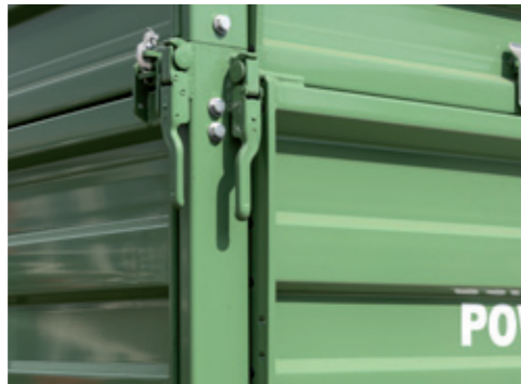
Hestalverschlüsse, ohne Bordwandversteifung
