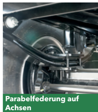
Parabelfederung unter Achsen
