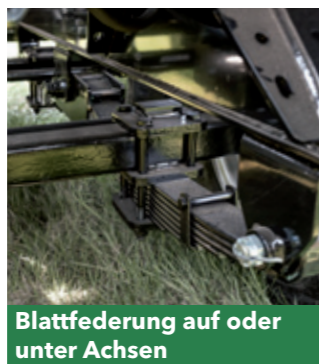
Parabelfederung auf Achsen
