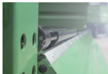
selbstreinigender Brückenrand nach allen vier Seiten gekantet
