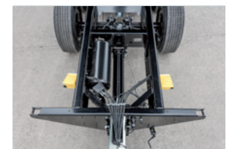
Rechteckrahmen aus G- oder Doppel-C-Pressprofilen
