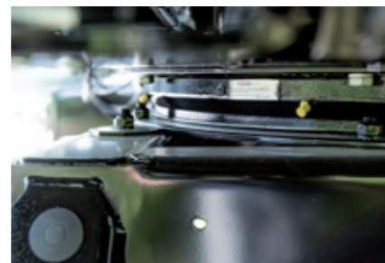
Kugellenkranz Schwerlast-Kugellenkranz aus dem LKW-Sektor
