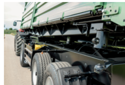
Trapezkipprahmen nach LKW Bauart mit weit außenliegenden Kipplagerungen
