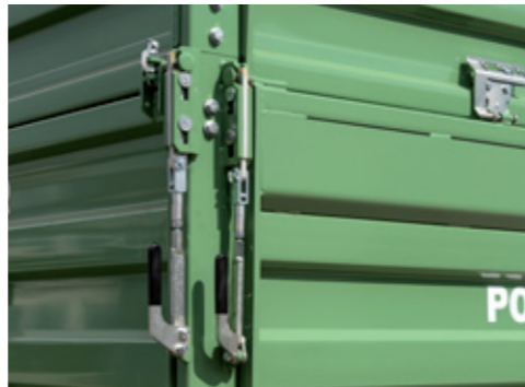
HB - LKW Verschlüsse, mit Bordwandversteifung
