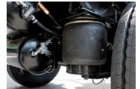
automatische Niveauregulierung für ein angenehmes Fahrgefühl
