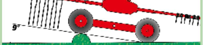
Beide Kreisel sind mit einem ① Drehgelenk ausgestattet und werden von einem Tastrad vorne ② außerhalb des Zinkenkreises (Patent) genau nach der Bodenkontur geführt.
