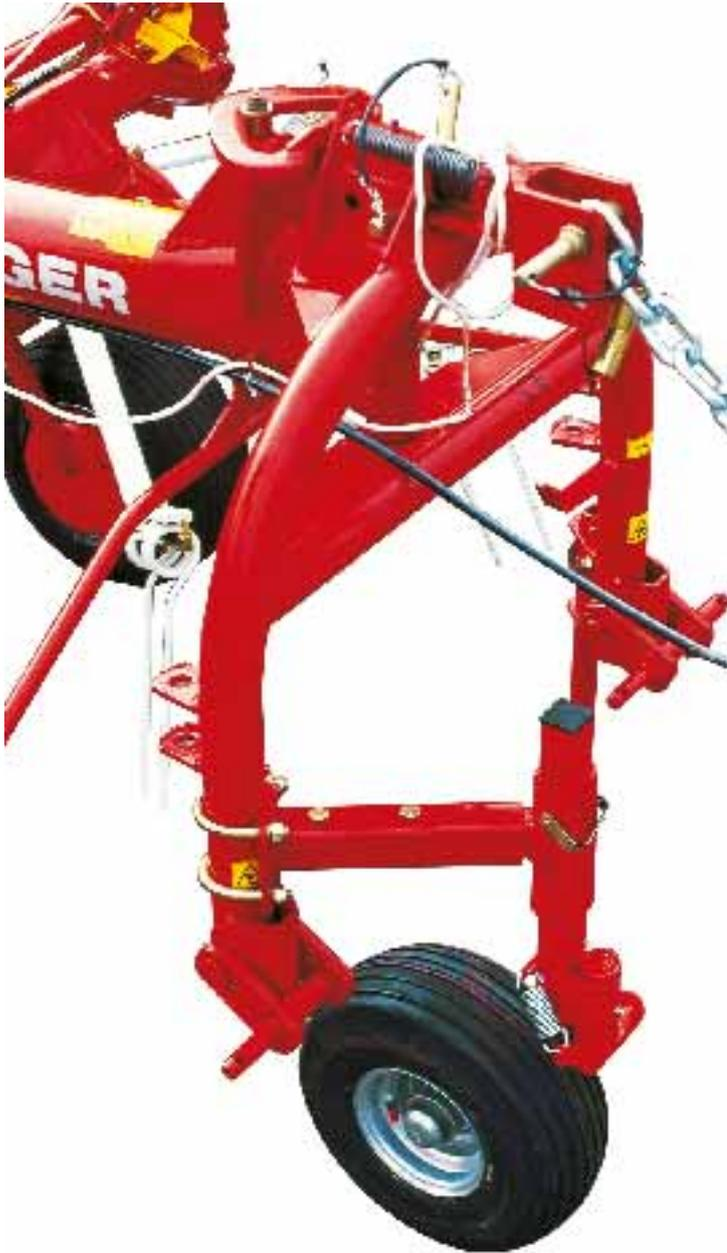
**N Der bewährte Schwenkbock** für Kurvenfahrt. Spurtreu folgt der Zetter dem Schlepper. Beim Anheben schwenkt die Maschine automatisch in die Mittelstellung. Kann auch am Hang nicht unterlaufen. Transportverriegelung
