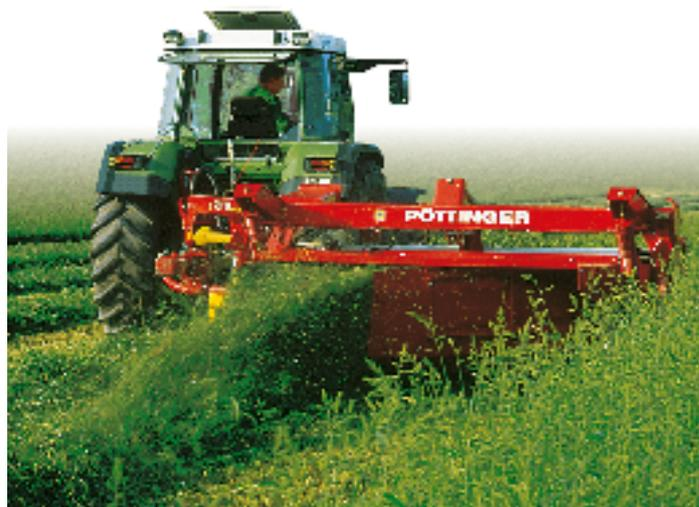
Jeweils 2 Einzelschwade können auf eine Gesamtbreite von ca. 3 m (2,70 m bei 260 T CR) aneinander gelegt werden. Die Schwadbleche werden hydraulisch vom Schleppersitz geschwenkt.
