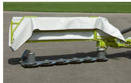
Die weit aufklappbaren Schutztücher erlauben den komfortablen Zugang zu allen Wartungspunkten.
