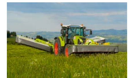
Durch die kompakte Aufhängung am Fronthubwerk verfügt das Mähwerk über große Bodenfreiheit am Vorgewende.
