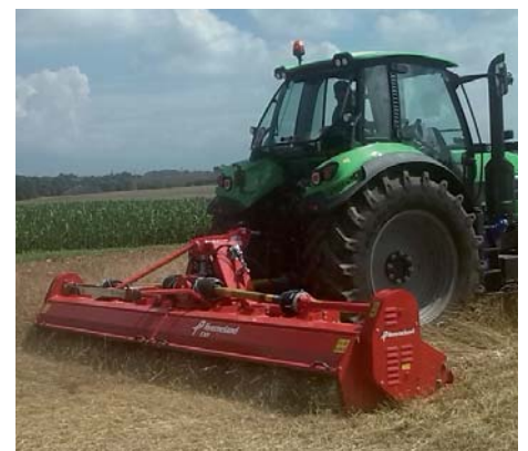
Das zentrale Getriebe (250 PS) ist mit Freilauf ausgerüstet; der seitliche Antrieb (5 Keilriemen je Seite) mit automatischem Riemenspanner steht für Verlässlichkeit und minimalen Wartungsaufwand.
