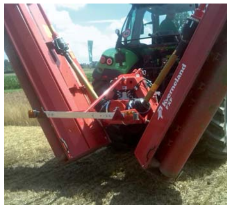
Der hydraulisch klappbare Rahmen stammt aus der Kverneland Kreiselleggenfamilie; robust und verlässlich auch unter harten Bedingungen. Die hydraulische Sperre ist Standard.
