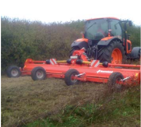
Halb schwenkbare Stützräder (10/8.0 x 12.8 ply) sorgen optional für Stabilität und eine konstante Arbeitstiefe.
