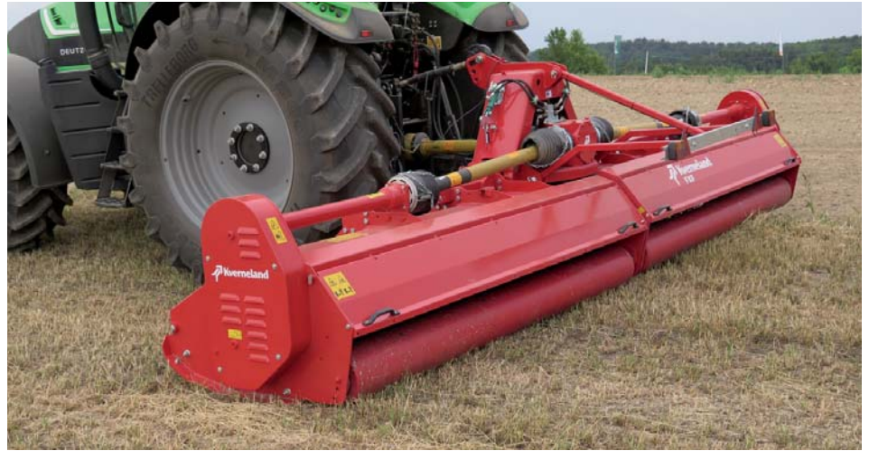
Arbeitsbreiten von 5,60 m bis 6,40 m. Die Walze (Ø 245 mm) läuft sehr nah am Rahmenprofil, um einen Selbstreinigungseffekt zu erzielen.
