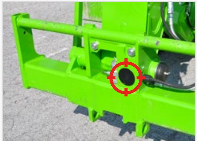
Am Anbaurahmen angebrachter Sensor
