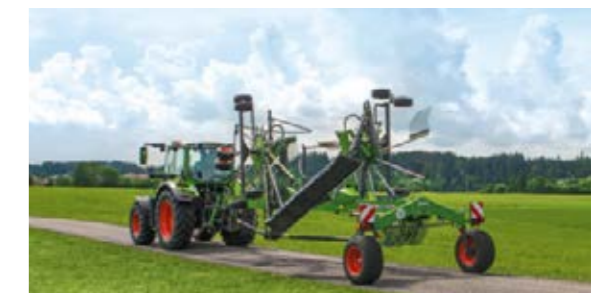
Auch die Fendt Former Zweikreiselschwader sind auf der Straße schnell und sicher unterwegs und klappen kompakt zusammen.
