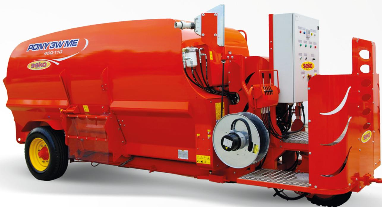
und gewährleistet dem Züchter sichere Ergebnisse und eine schnelle Amortisierung der Investition. Schneckenförderer aus hochfestem, dickem Stahl, extrem stabil und robust für eine lange Lebensdauer. Patentiertes Zerkleinerungs- und Mischsystem „Double Mix“, das sich durch zwei spezielle Doppelspiralschnecken auszeichnet, die sich gegenläufig drehen und mit Sternmessern und Gegenmessern ausgestattet sind; sie befinden sich am Boden der Wanne und sind in
