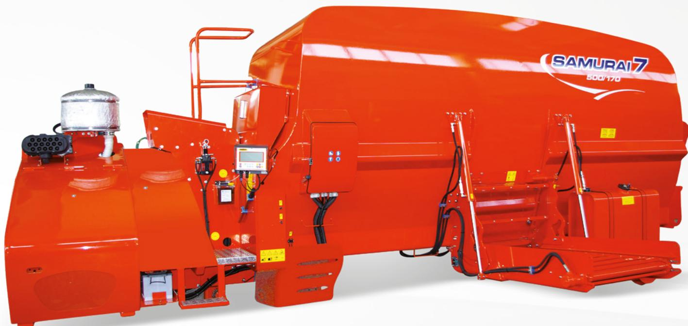
Arbeitsautonomie. Besonderes Augenmerk wurde auch auf das neue Kühlsystem mit verstopfungsfreien Kühlern gelegt, um maximale Funktionalität in allen klimatischen Situationen zu gewährleisten. Sowohl der Motorraum als auch die zentrale Steuerkonsole sind für alle Steuerungs- und Wartungsarbeiten der Maschine leicht zugänglich. Flexibilität und Sicherheit werden durch das hydrostatisch angetriebene Getriebe mit automatischer Umkehrung der Schneckenbewegung
