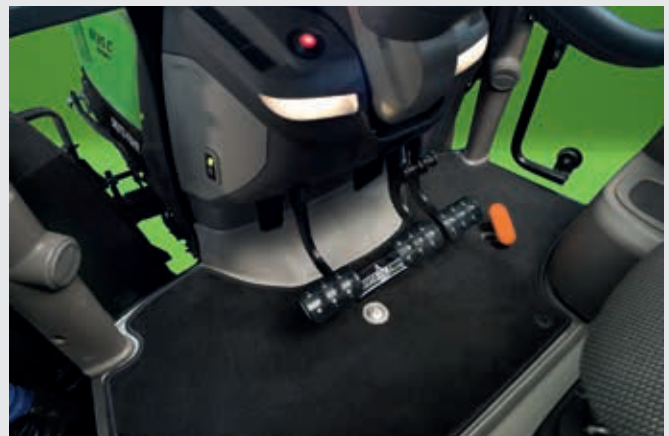
Activation du frein moteur hydraulique.
