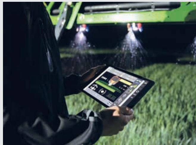
↑ Fonction XTEND avec tablette, contrôle des outils via ISOBUS UT tout en étant hors de la cabine.
