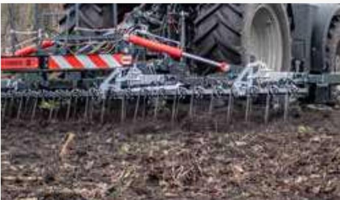
Das gezielte Ausklopfen und Ausschütteln von Wurzelballen und Schotten nach der Ernte und vor der Saat sorgt für einen maximalen Auflauf von Samen. Der Striegel in Doppelreihe sorgt hierbei mit seinem engem Strichabstand für dennoch hohen Durchgang und gleichmäßige Einebnung. Durch seine vielen Einstellmöglichkeiten lässt er sich optimal an unterschiedlichste Gegebenheiten anpassen.
