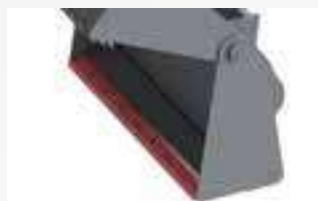
Geschraubte Schürfleiste 150 x 20 mm (500 HB) im Schaufelrücken
