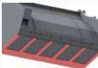
Verstärkter Unterbau mit hoch- verschleißfester Schürfleiste 150 x 16 mm (500 HB)
