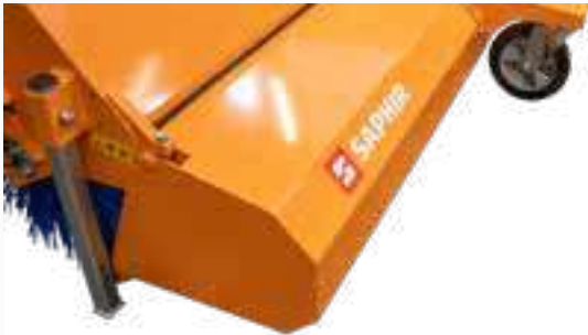
Hydraulische Schmutzsammelwanne mit 3. Stützrad
