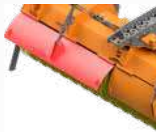
Mechanisch verstellbarer Spritzschutz an der Frontseite der Kehrmaschine
