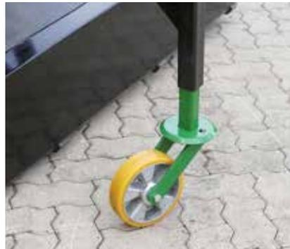
Bei Aufnahme in der Front wird ein 3. Stützrad empfohlen.
