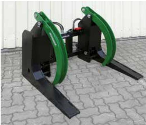
Der Holzgreifer mit zweifachem hydraulischem Oberarm ermöglicht ein sicheres und praktikables HolZRücken, Poltern und Verladen von Rundstämmen vom Trägerfahrzeug aus. Die große Öffnungsweite ermöglicht eine sichere sowie schnelle Aufnahme von mehreren Stämmen auf einmal.
