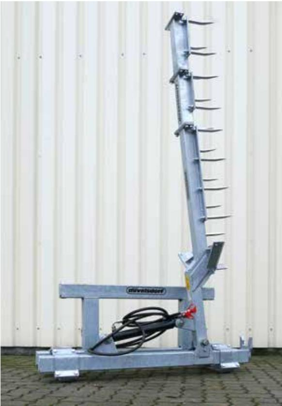
Der düvelsdorf Boxenplaner eignet sich zum Auflockern und Verteilen von Einstreu in Liegeboxen. Das Gerät kann mittels EURO-Aufnahme an das Trägerfahrzeug gekoppelt werden und lässt sich über ein DW Steuergerät in Arbeitsposition schwenken.
