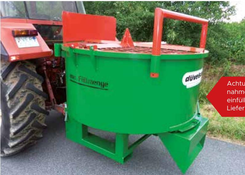
**Achtung!** Vor Inbetriebnahme Öl in Getriebe einfüllen! Öl ist nicht im Lieferumfang enthalten.
