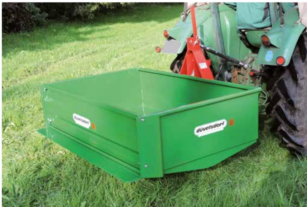
Ein praktischer Heckcontainer für den 3-Punkt-Anbau mit besonders robuster Verarbeitung und mechanischer Kippvorrichtung.
