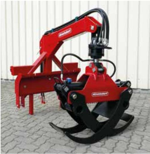
Die Forstzange mit Rotator eignet sich zum Stapeln und Rücken von Holzstämmen. Der Endlosrotator mit einer Traglast von 4,5 t und der Greifer mit 1560 mm Öffnungsweite ermöglichen ein komfortables Arbeiten. Der Anbau kann sowohl mit EURO Aufnahme am Frontlader erfolgen, als auch in der Dreipunkt mit KAT 2 Aufnahme.
