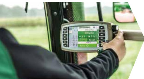
Zusätzlich zur Nutzung eines Smartphones / Tablets kann die Bedienung (auch parallel) über ein ISOBUS-Terminal erfolgen.
