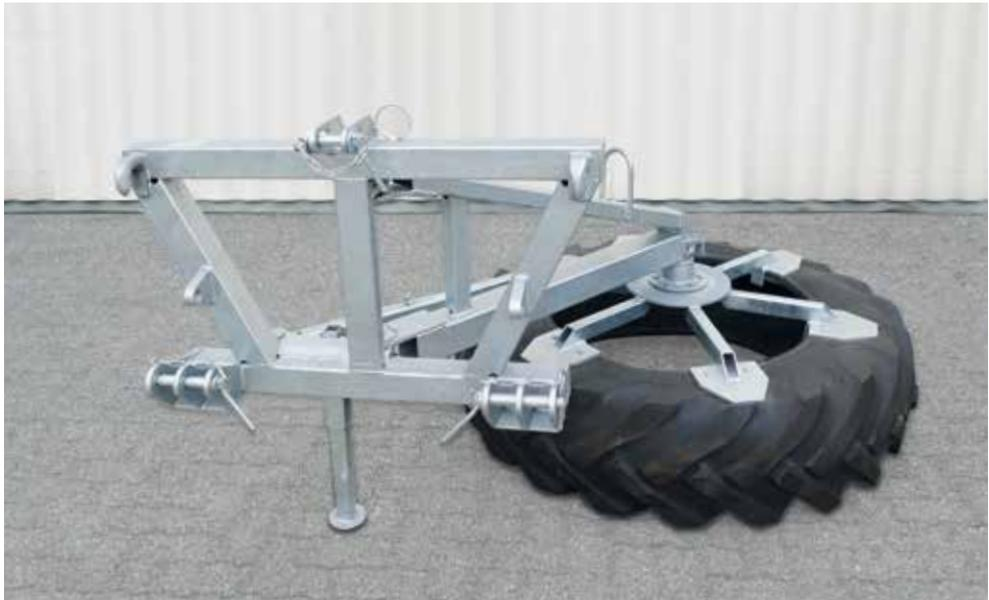
Das Gerät lässt sich mechanisch nach rechts und links schwenken. Optional ist eine hydraulische Verstellung mittels doppelwirkenden Zylinder möglich. Der Anbau erfolgt entweder über Dreipunkt KAT 2, der bei der Kombiauflage über EURO und Dreipunkt KAT 2 oder über die Greifschaufelaufnahme. Der Antrieb des rotierenden Rades (nicht im Lieferumfang enthalten) erfolgt über den Boden.
