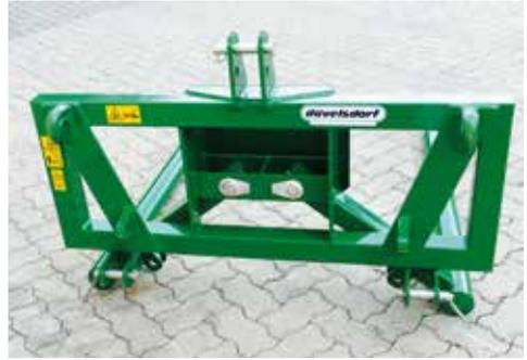
Die Rundballengabel solo ist durch die Aufnahme in EURO und KAT 2 universell einsetzbar. Über die frei beweglichen Arme ist die Aufnahme von Rundballen mit einem Durchmesser von 0,80 m bis 1,30 m ohne Umstellen der Arme möglich. Optional kann die Rundballengabel mit einem Zylinder ausgestattet werden, mit dem sich die Arme hydraulisch auf die Ballengröße einstellen lassen. Bei Wickelballen größer 1,3 m kann es beim Aufnehmen zu Beschädigungen an der Folie kommen.
