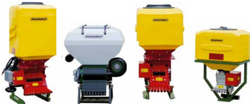
Angeboten werden Säeinrichtungen in unterschiedlichen Ausführungen, um für jeden Einsatzzweck die passende Maschine bieten zu können. Unterschiede bestehen bei der Anzahl der Ausgänge und deren Durchmesser, sowie beim Gebläseantrieb und der daraus resultierenden Förderleistung.
