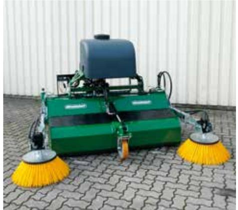
Optimiert für den Frontanbau an Schlepper, Hof-, Rad- und Teleskoplader oder Stapler
