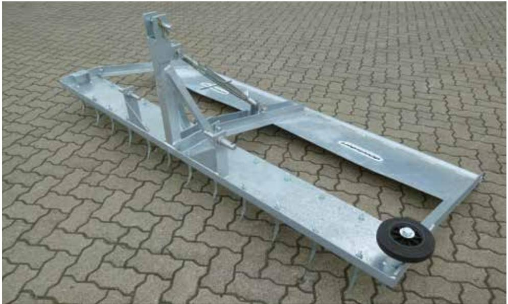
Feuerverzinkter Rahmen mit 1,50 m, 2,00 m oder 2,50 m Arbeitsbreite. 3-Punkt-Anbau. Für jeden Reitplatzboden geeignet.
