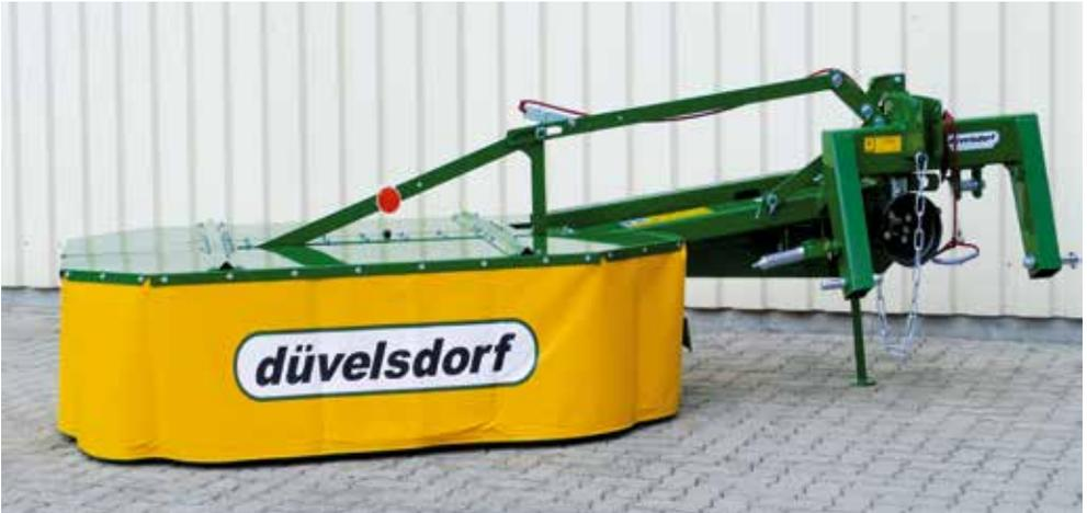
Die düvelsdorf Trommelmäherwerke **d**CUT sind für den Einsatz auf allen Weiden und Feldern konzipiert. Egal ob als Zweitgerät für Großbetriebe, als Einzelgerät im Nebenerwerb oder auf Kleinbetrieben – dieses Mäherwerk ist für alle Betriebsgrößen geeignet. Beim Schwenken in Transportstellung muss die Gelenkwelle abgebaut werden.
