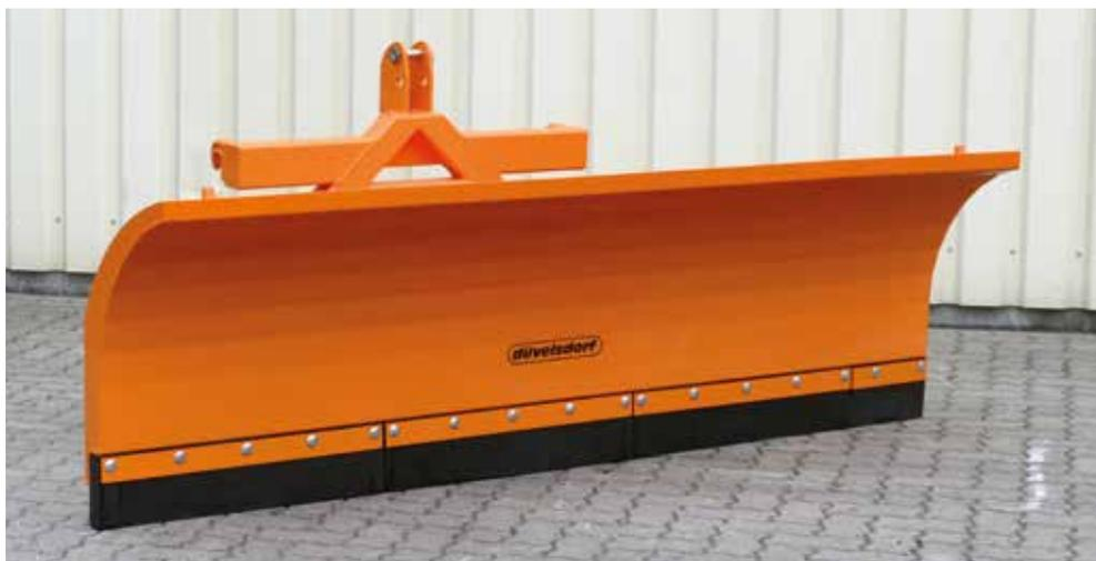
Das Schneeschild mit einer Arbeitsbreite von 2,00 m bis 2,90 m ist geeignet, um Wege und Straßen zu räumen. Die Gummileiste verhindert Schäden am Straßenbelag. Standardmäßig ist das Schneeschild Komfort mit einer Kombiauflage für 3-Punkt und EURO ausgerüstet.
