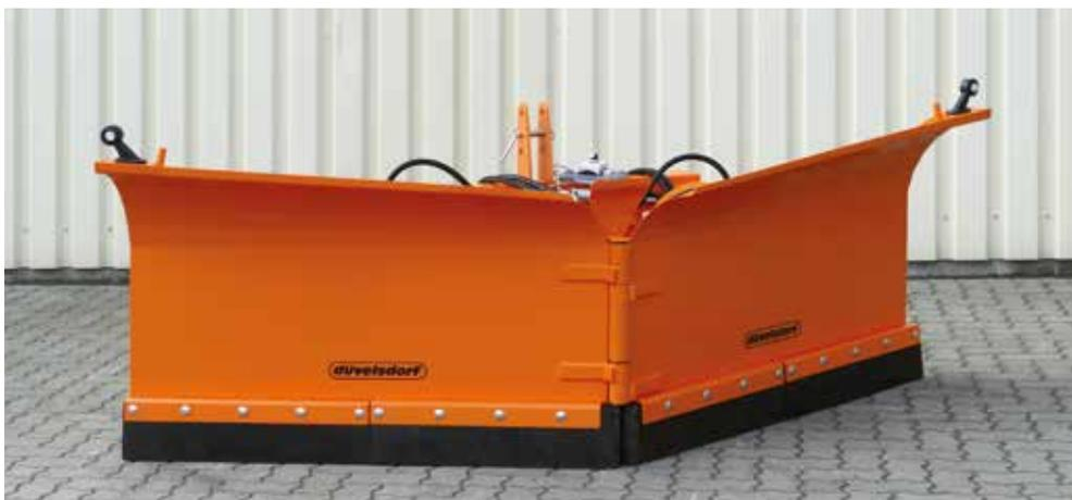
Der düvelsdorf Schneepflug besteht aus zwei mittig gelagerten Scharflügeln, die hydraulisch individuell verstellbar sind. Durch die flexiblen Einstellmöglichkeiten links, rechts, gerade und als Pflug ist das Schneeschild optimal einsetzbar in den verschiedenen Geländen wie Straßen, Plätzen und Höfen.
