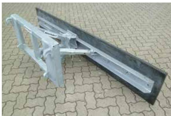
2,60 m für EURO-Aufnahme mit mechanischer Schrägstellung. Ideal zum Säubern von Futterflächen und Vorlegen von Futter. Optional ist eine hydraulische Verstellung lieferbar.
