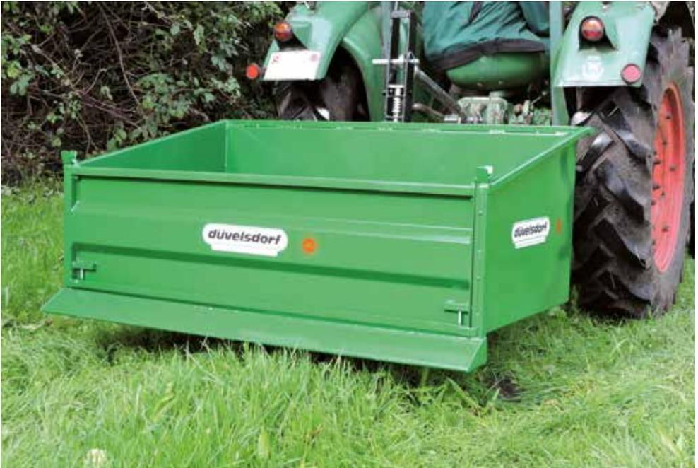
Heckcontainer können als Transportbehälter für Werkzeug und Schüttgüter verwendet werden. Der Heckcontainer Standard verfügt über eine pendelnd aufgehängte, abnehmbare Heckklappe und eine Schürfleiste.
