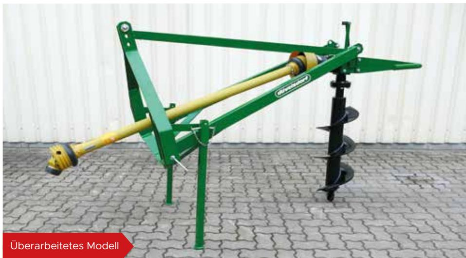
Der düvelsdorf Erdbohrer wird mit einem Bohrkörper geliefert. Zur Auswahl stehen Bohrkörper mit einem Durchmesser von 150 mm, 300 mm und 450 mm. Die Bohrkörper sind mit auswechselbaren Schneidmessern ausgestattet. Die mitgelieferte Gelenkwelle ist mit einer Rutschkupplung ausgestattet. Sie treibt das Ölbadgetriebe an. Die Bohrtiefe beträgt 100 cm. Die Konstruktion ermöglicht ein platzsparendes und sicheres Abstellen sowie ein An- und Abkoppeln an den Schlepper.
