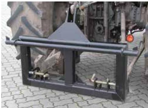
Wenn Sie Geräte für den 3-Punkt-Anbau auch an den Frontlader mit EURO-Aufnahme anhängen möchten, nutzen Sie dafür den Frontladeradapter. Traglast ca. 1000 kg. Oberlenkerverbindung evtl. erforderlich.
