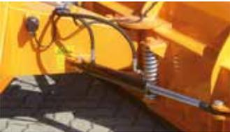
Hydraulische Schrägstellung (optional)
