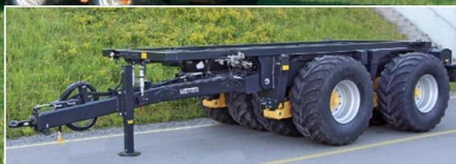
Système d'essieu 8-20SL sous châssis multi-benne
