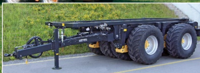
Fahrwerk 8-20SL mit Zwanglenkung verbaut in Wechselchassis
