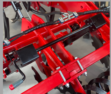
zentrale Verstellung der Einebungsscheiben
