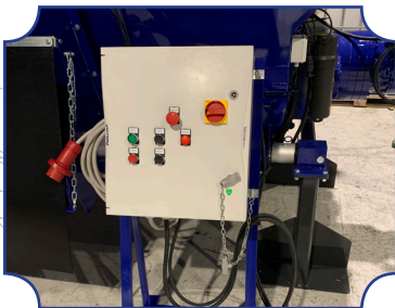
Optional: Steuertafel. Erhältlich als Soft- Start oder Inverter- Motorstart.
