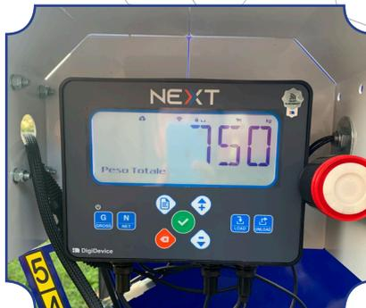
Das Automatische Wiegesystem NEXT von Digidevice ermöglicht das programmieren von bis zu 50 Rezepten sowie 20 Mischkomponenten. Wahlweise kann das Wiegesystem via Wifi mit dem Handy verbunden werden.
