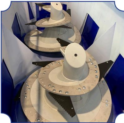
Die perfekt zum Tank abgestimmten Mischschnecken sind mit Borstahlmessern ausgestattet. Wahlweise können diese auch mit Wolframbeschichtung montiert werden. Ebenfalls ist eine verschraubte Chromstahl Verschleissplatte erhältlich.
