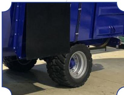
Der Mischwagen ist mit niedrigen Breitreifen für eine gute Stabilität und sicheres Fahrverhalten ausgestattet.
