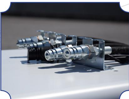
Standartmässig werden die Hydraulikfunktionen ab Traktorgespiesen. Auf Wunsch gibt es eine Bordhydraulik mit elektrischer Bedienung.
