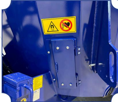
Der Magnet ist so angeordnet, dass er bequem von aussen gereinigt werden kann.
