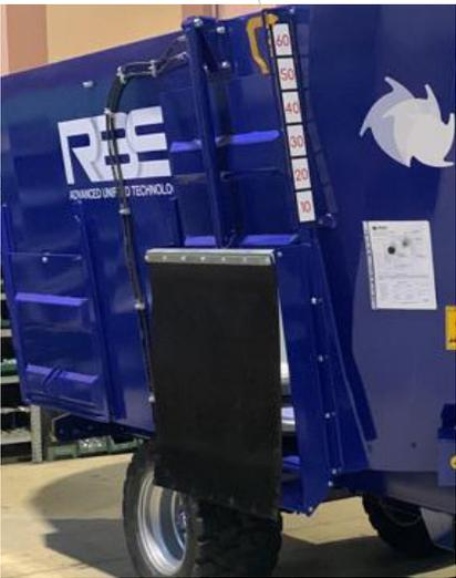
Standartmässig hat der Mischwagen einen Ablad vorne rechts. Auf Wunsch sind Entladeöffnungen links, rechts sowie vorne und hinten möglich.
