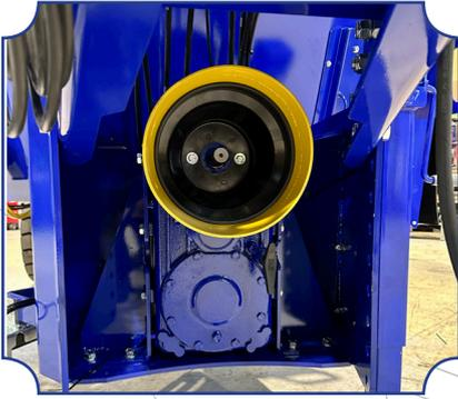
Optional ist die Montage eine 2 Gang Getriebes möglich.
