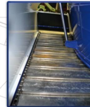
Beidseitiger kettenauslauf vorne (Optional: Kette und Boden aus rostfreien Stahl oder Gummiband).
