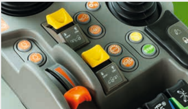
↑ Einfaches Zuschalten der Front- und Heckzapfwelle durch Tasten auf der MaxCom-Armlehne.
