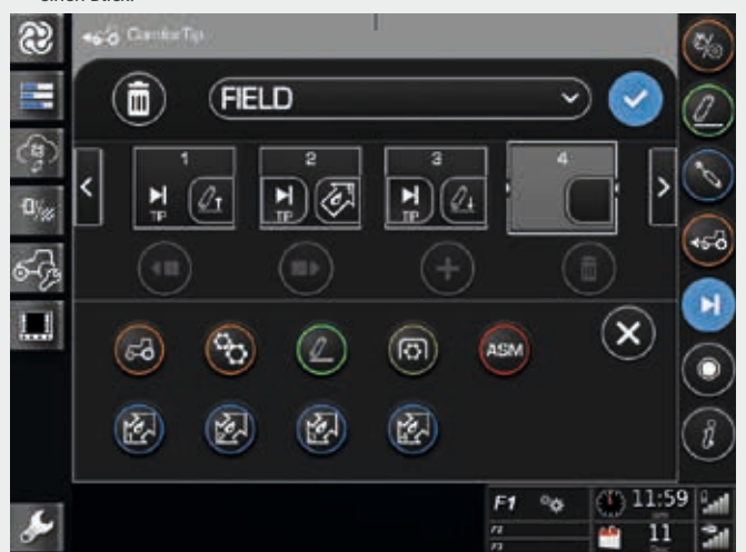
↑ Zusätzlicher Komfort durch das ComforTip-Vorgewendemanagement. Es ermöglicht die Aufzeichnung von wiederholenden Bedienabläufen und deren Abruf per einfachen Tastendruck.
