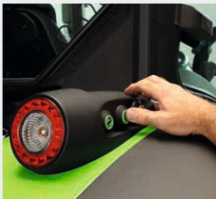
↑ Heckkraftheber und Zapfwelle können mit externen Bedienelementen an den Heckkotflügeln bedient werden.
