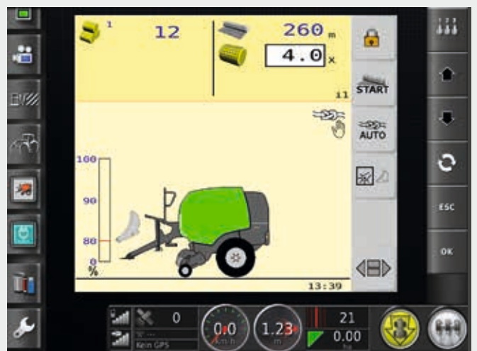
Universal-Terminal zur Steuerung beliebiger ISOBUS-Geräte.
