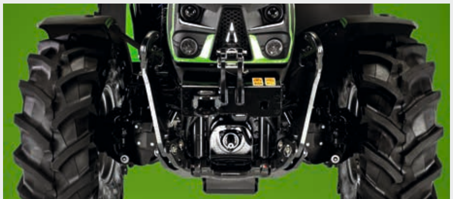
↑ 5D TTV-Modelle können mit einem Frontkraftheber mit 2100 kg Hubkraft und optionalem Komfortpaket ausgestattet werden.
