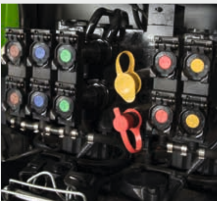
↑ Bis zu 5 Zusatzsteuerventile im Heck.
