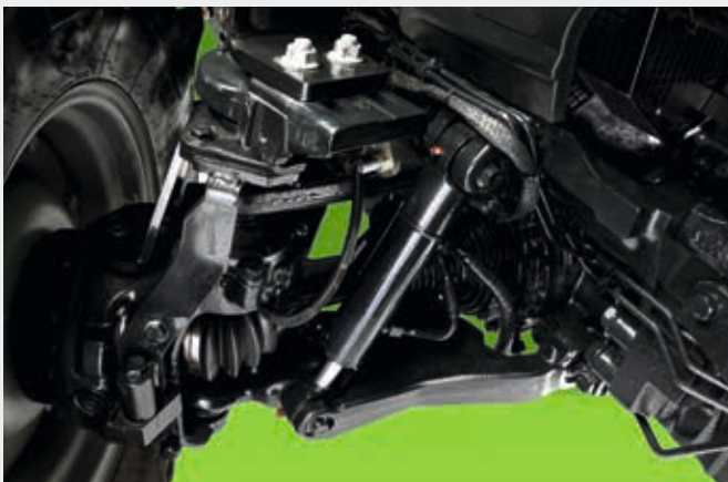
↑ Gefederte Vorderachse mit Vorderradbremßen.
