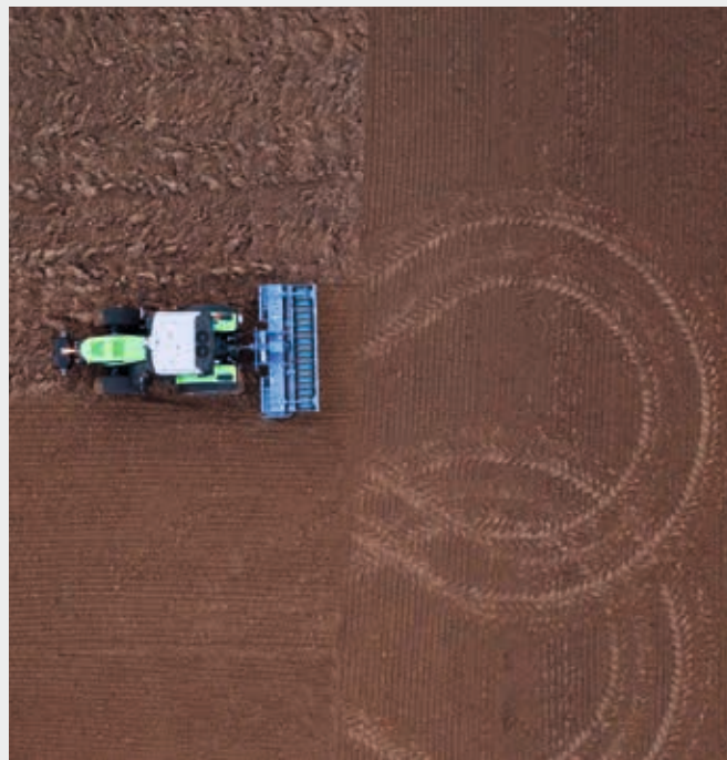
📌 SDF Guidance: Viele Funktionen, wie Auto-Turn (automatisches Wenden) für höchsten Komfort.
