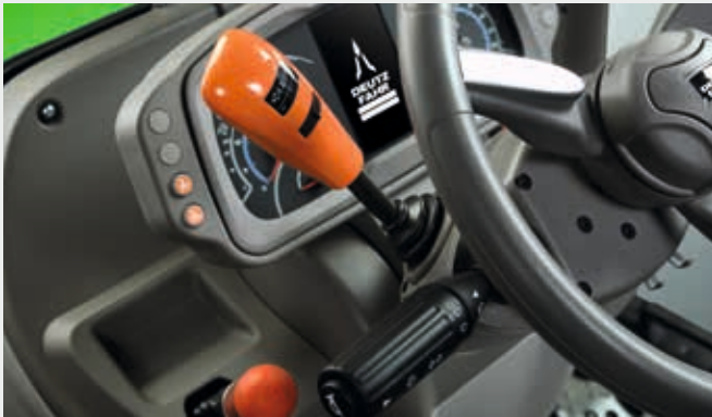
↑ PowerShuttle mit 5 Reaktionsstufen.
