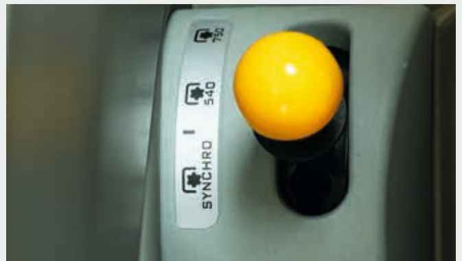
↑ Vorwahl der Zapfwelldrehzahl.
