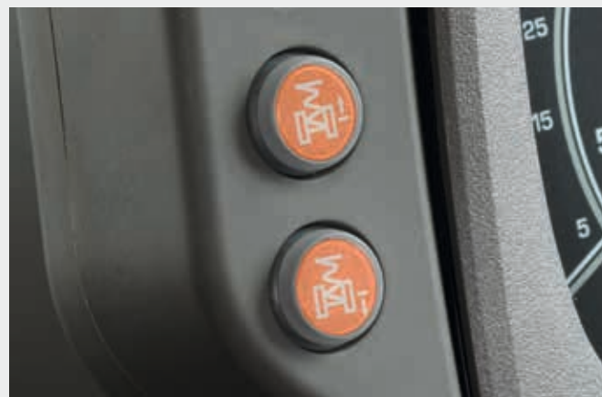
📌 Zwei neue Tasten erlauben die manuelle Einstellung der Position der Vorderachsfederung.
