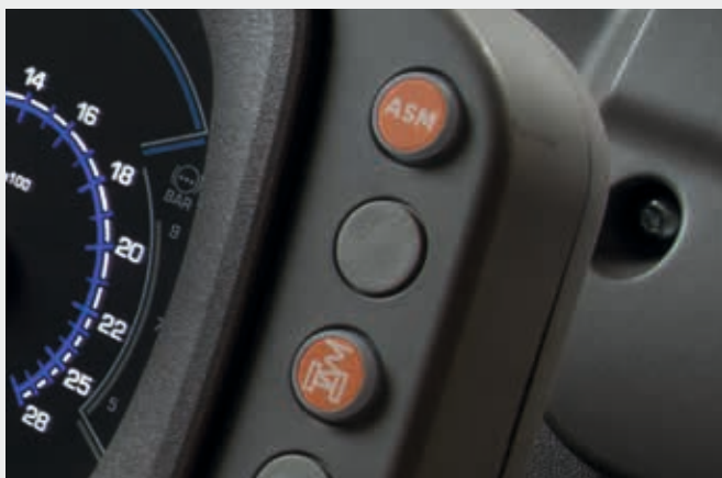
📌 Aktivierung des ASM-Systems und der Vorderachsfederung.
