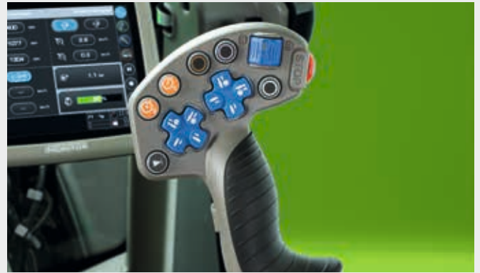
↑ MaxCom-Joystick für die einfache Bedienung des TTV-Getriebes und weiterer Traktorfunktionen.
