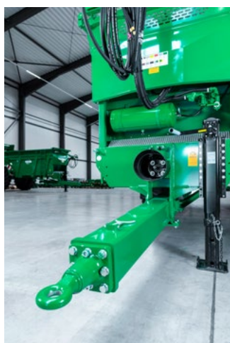
Bild links: Die serienmäßige Untenanhängung mit Ringzugöse 50 mm. Die Fahrzeugkomponenten sind durch eine Abdeckung vor Außeneinwirkungen geschützt.
