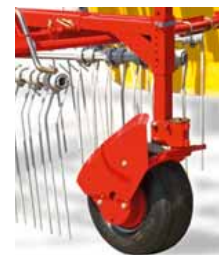
Der Wickelschutz verhindert ein Wickeln von Futter um das Multitastrad und den Radbügel.
