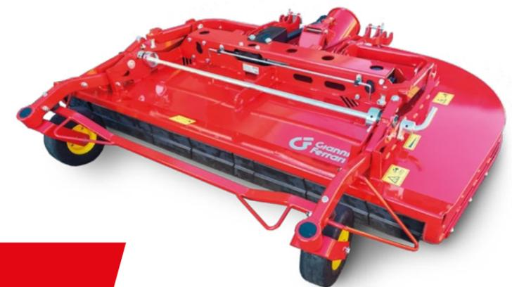
Der **Messerantrieb ist durch** die Ölbad-Getriebe mit Sphäroguss-Gehäusen sowie spiralverzahnten Kegelräder **robust und zuverlässig**. Die Scheiben mit **pendelnd aufgehängten, überlastsicheren Messern** schützen den Antrieb vor Schäden durch Fremdkörper.
